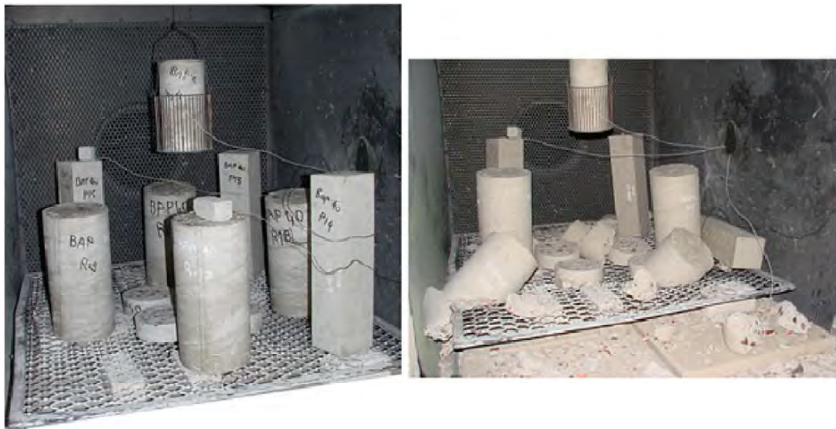
Figure 3.19: les éprouvettes avant et après chauffage [Hana 09]
