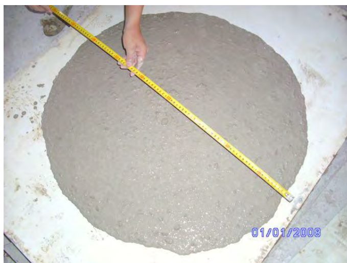
Figure 4.2 : la galette d'étalement des BAP
