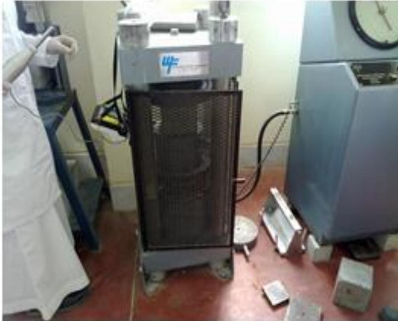
Figure.4.18 : Mise en place du bâti de compression
