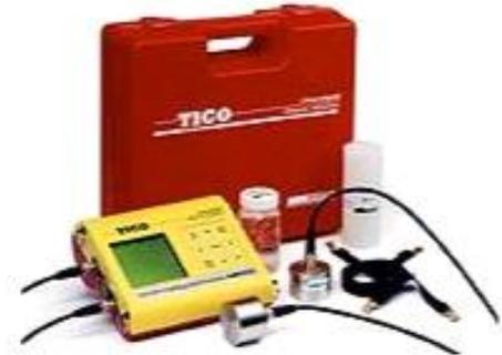
Figure.4.1 : Appareillage utilisé lors des essais aux ultrasons
