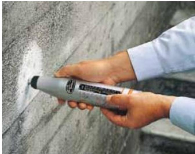
Figure.4.5 : Pratique de l'essai au scléromètre sur un mur de béton
