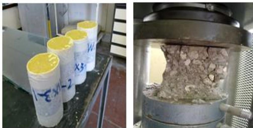
Figure.4.17 : Essai de compression sur éprouvettes cylindriques en béton
