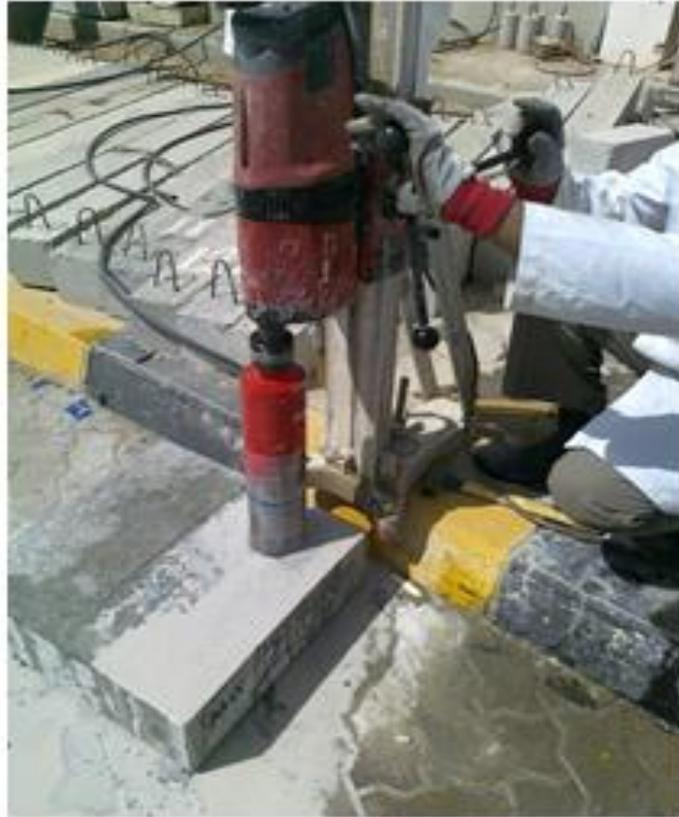
Figure.4.16 : Mise en place d'un carottier à la surface d'une dalle en béton.
