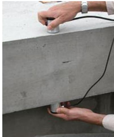
Figure.2.17 : essai transparent sur une poutre à l'aide de l'appareil à ultrasons Tico
