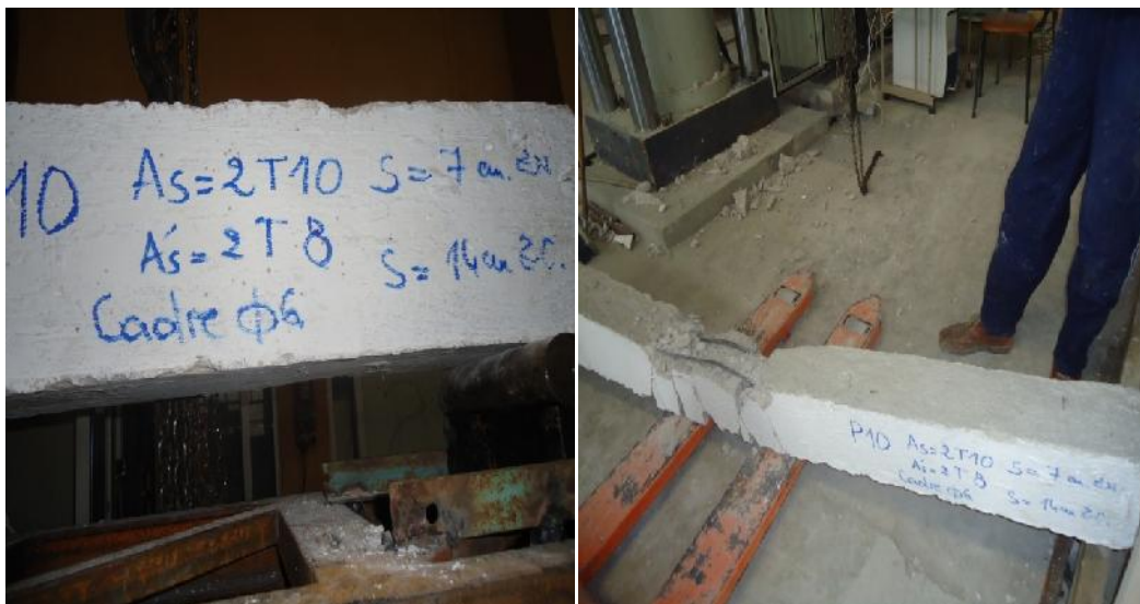
Figure IV.40 : Endommagement de la poutre P10
