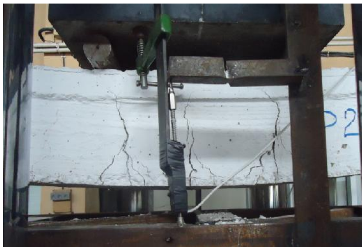
Figure IV.25 : Propagation et ouverture des fissures de la poutre P2
