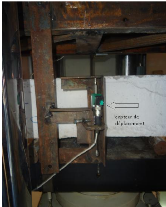
Figure IV.17 Fixation et mise en place du capteur de déplacement
