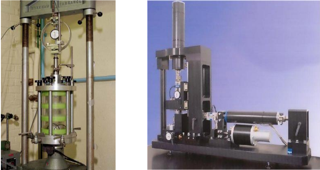
Figure 3. 1. Essai triaxial de révolution (à gauche) et essai à la boîte de cisaillement direct (à droite)
