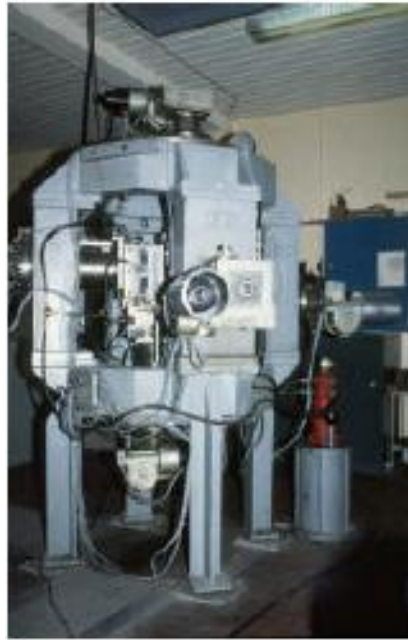
Figure 3. 2. Appareil de l'essai triaxial « vrai »
