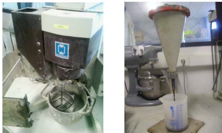
Figure 2.12: Préparation du coulis (malaxage et écoulement au cône de Marsh)
