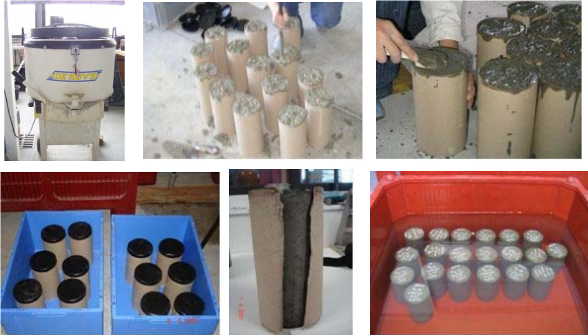
Figure 4.1: Etapes de gâchage, confection et conservation des éprouvettes de bétons
