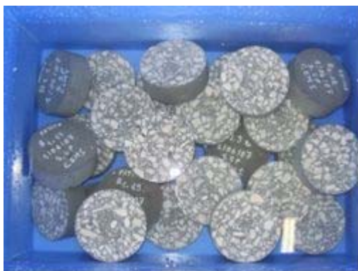
Echantillons conservés dans l'eau pendant 24 h
