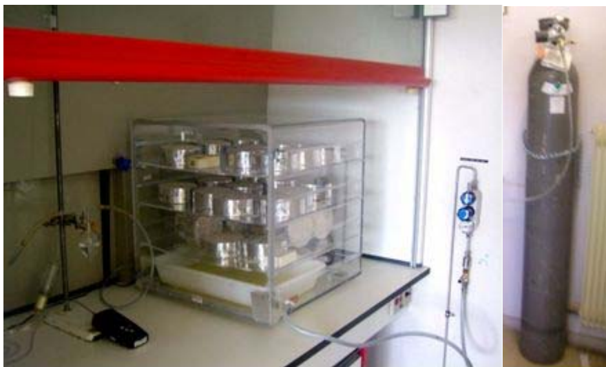
Figure 4.23: Vue générale du dispositif de carbonatation accélérée du CRMD
