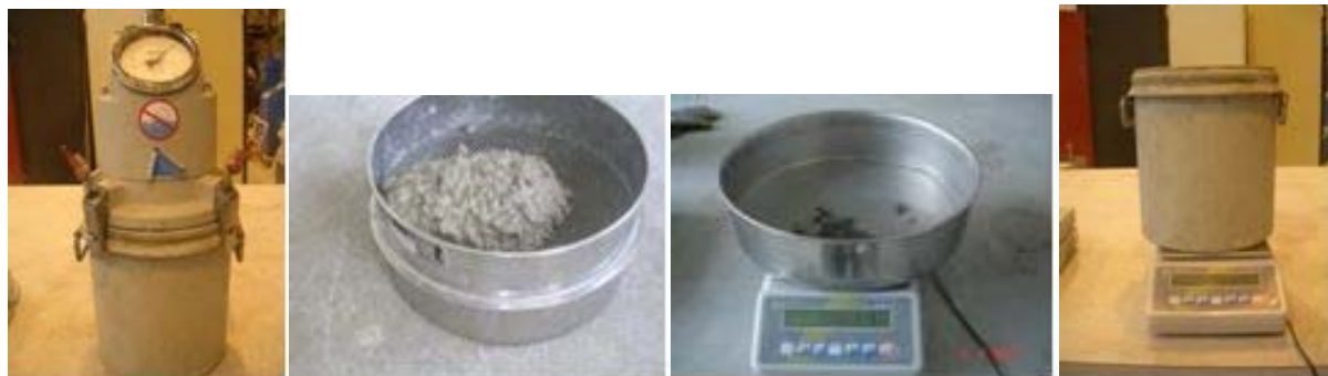
Figure 4.4: Mesure de la teneur en air, de la stabilité et de la masse volumique expérimentale
