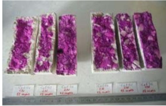
Figure 5.10: Fronts de carbonatation naturelle (12 mois) visualisés suite à la pulvérisation de phénolphtaléine pour les six bétons.
