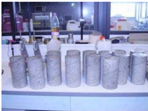
Eprouvettes sorties de l'eau après 28 jours
