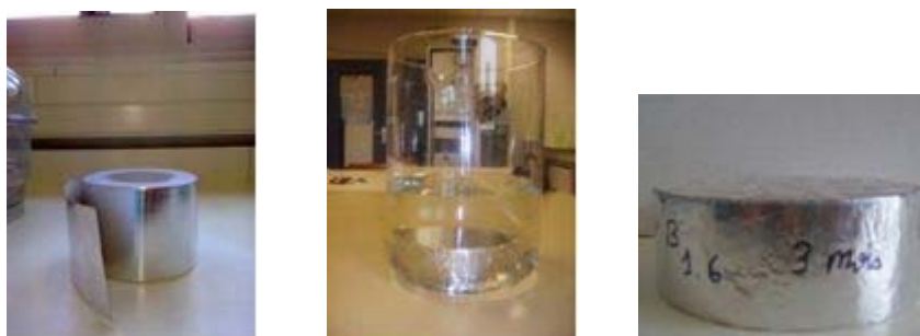
Figure 4.25 : Vérification de l'imperméabilité de l'aluminium et emballage des échantillons
