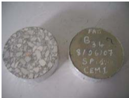
Figure 4.24: Types d'échantillons utilisés : béton de cœur (gauche) et béton de fond (droite)
