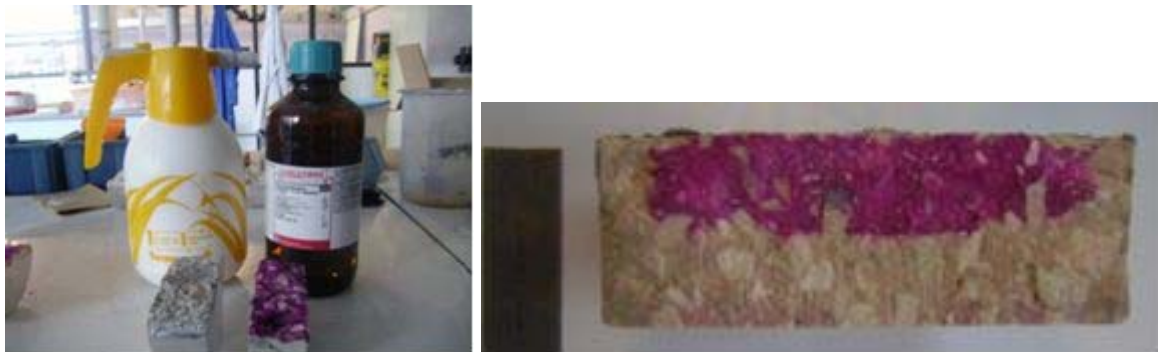
Figure 5.2: Test à la phénolphtaléine et mesure du front de carbonatation
