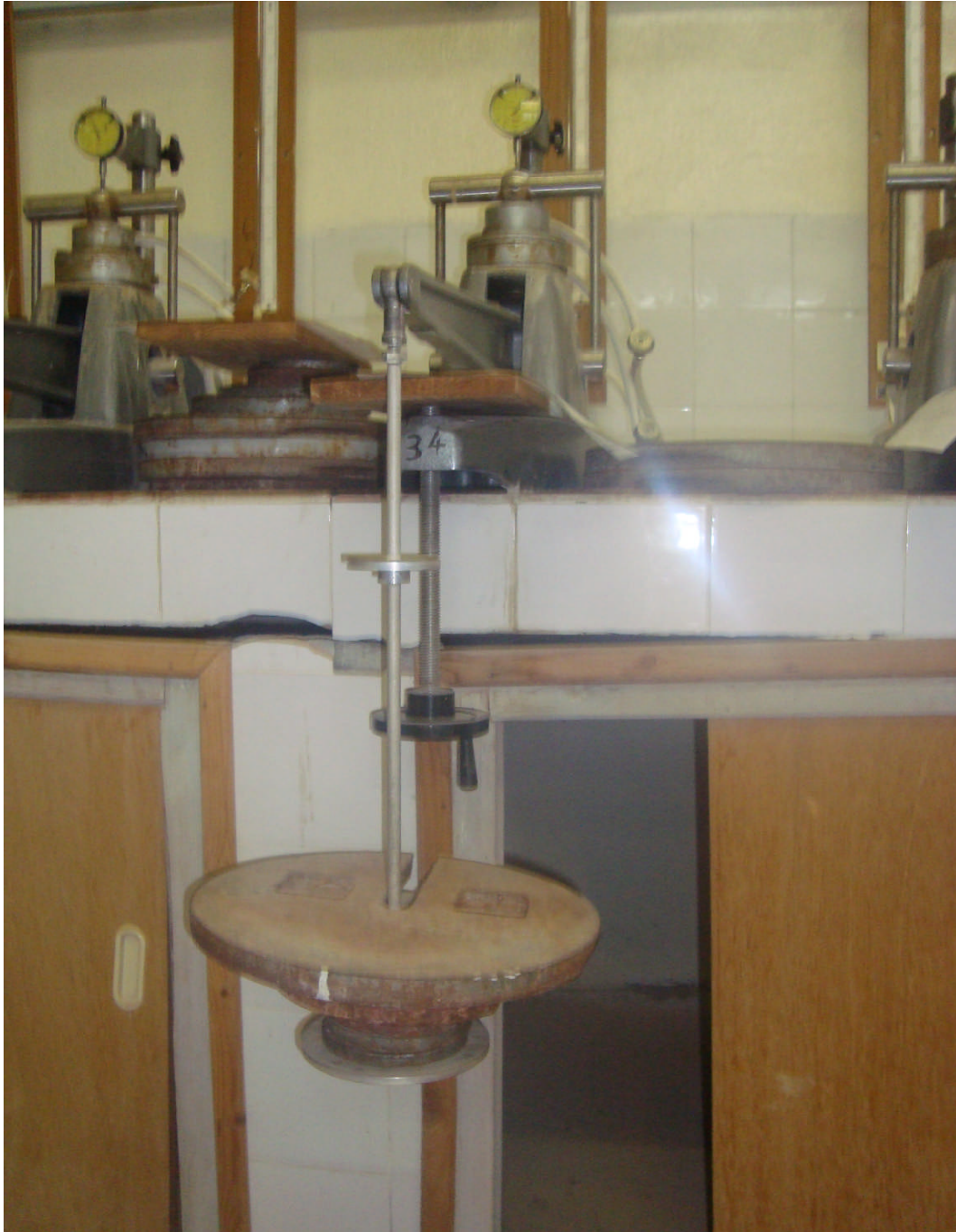
Photo III-2-12 : Essai de déchargement
