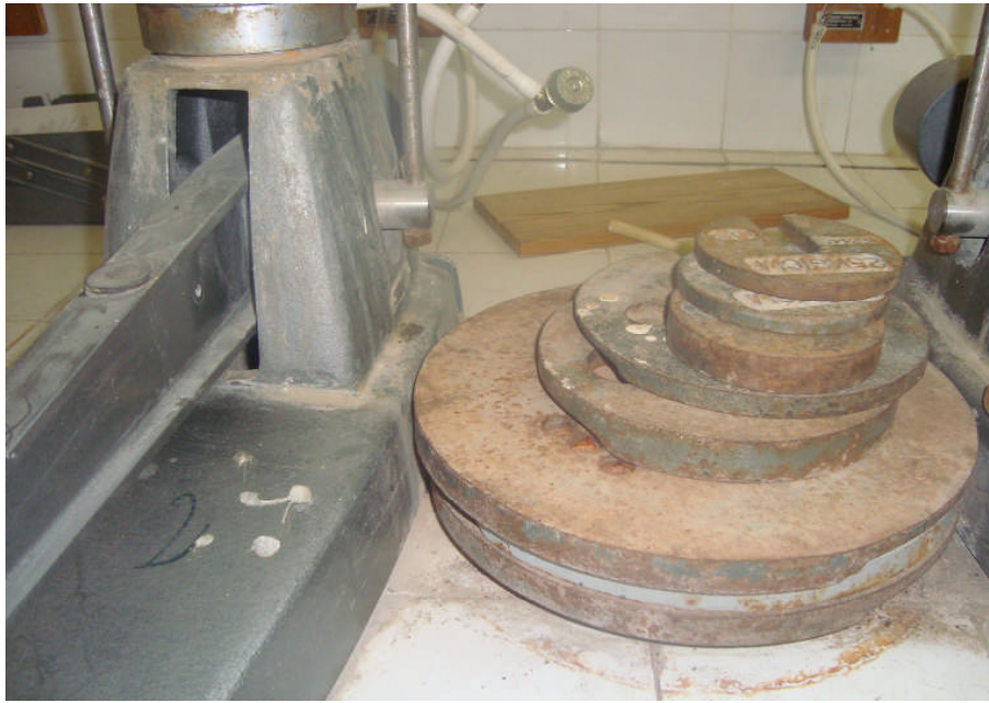
Photo III-2-9 : Différents poids utilisés successivement pour l'essai
