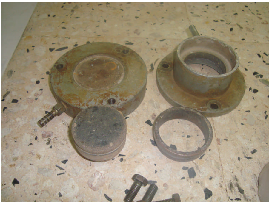
Photo III-2-1 : Différents pièces constituant la cellule oedométrique
