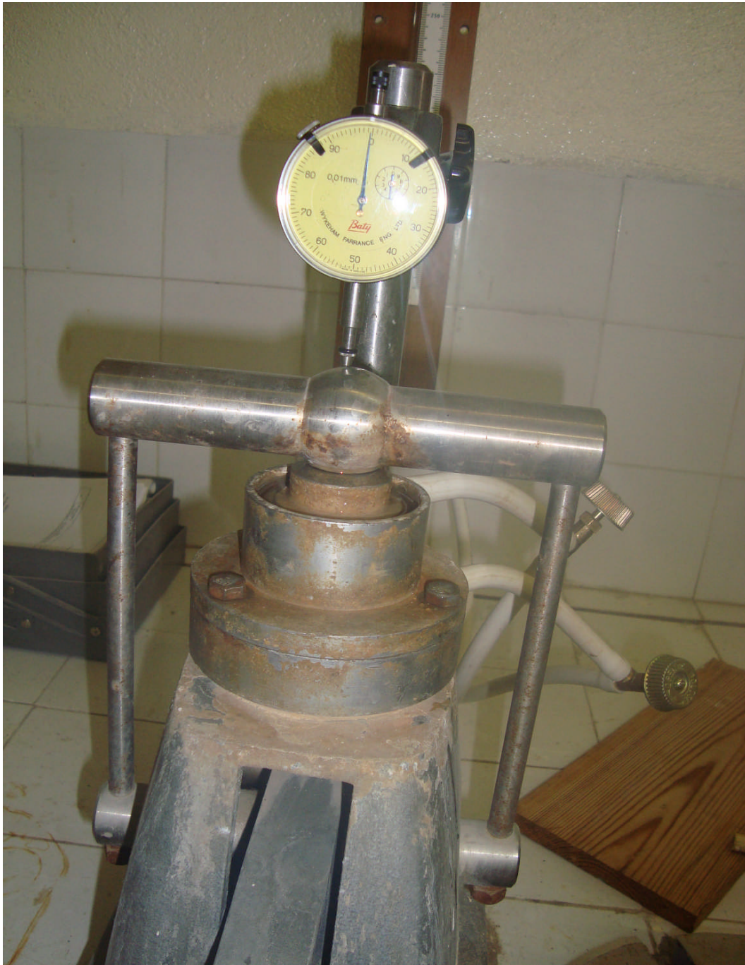
Photo III-2-8 : Moule placé dans le bâti avec l'étrier de chargement
