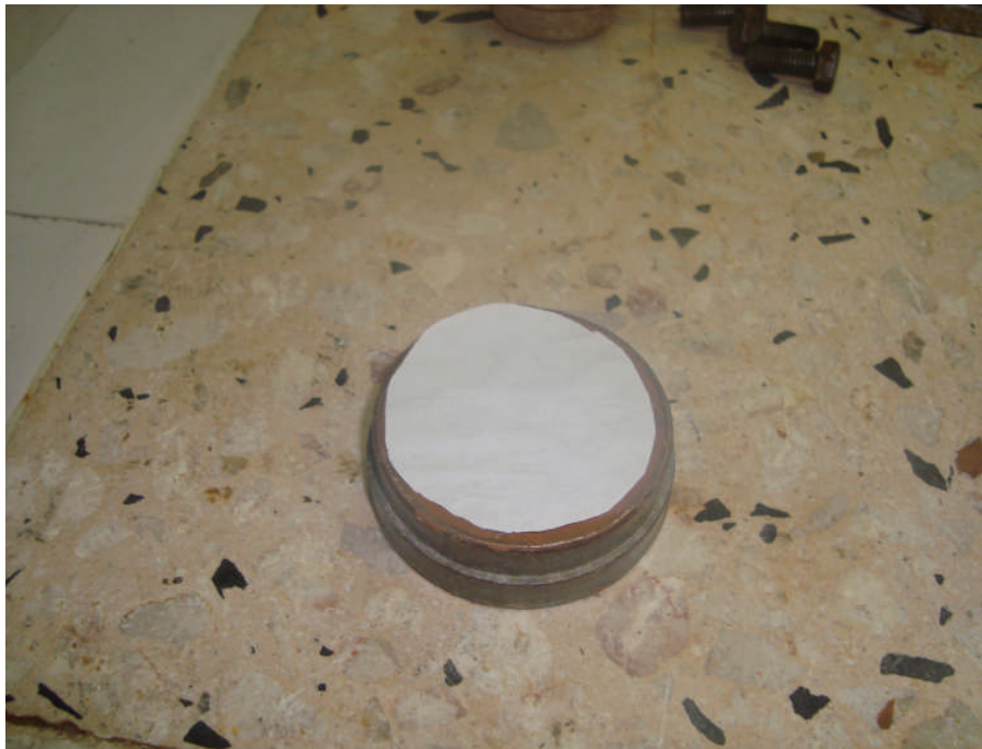
Photo III-2-4 : Echantillon arasé et recouvert d'un papier filtre supérieur
