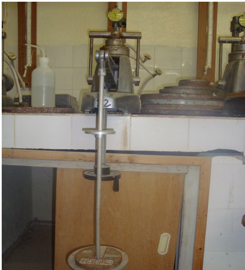
Photo III-2-10 : Lecture du déplacement sur le comparateur après stabilisation
