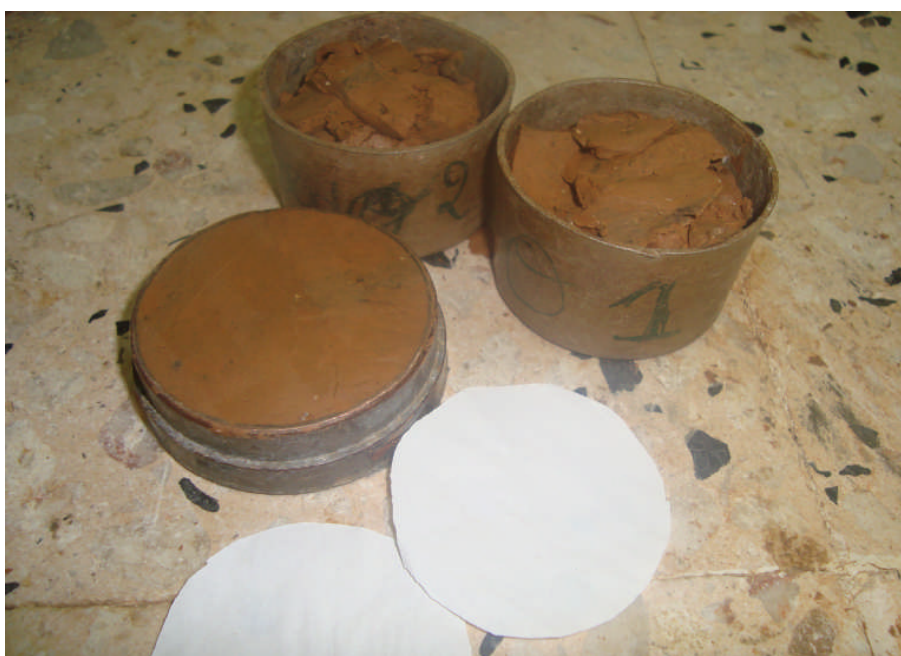
Photo III-2-3 : Echantillon taillé placé dans le moule
