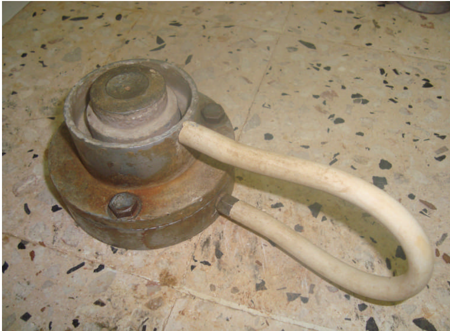
Photo III-2-6 : Moule recouvert du disque drainant supérieur
