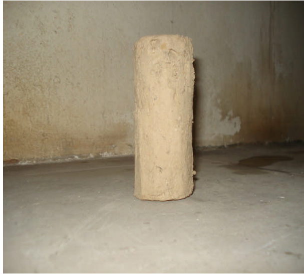
Photo III-2-13 : Eprouvette utilisée pour l'essai triaxial
