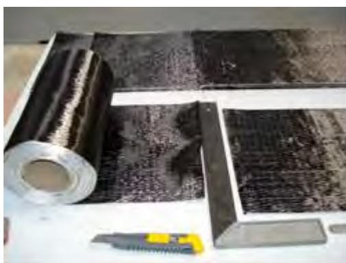
Figure II.2. 3: Mesure et découpage du tissu en fibres de carbone (SikaWrap-230 C/45)
