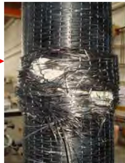
**Figure II.3. 19** : Colonnes ( $\text{Ø}155 \times 1000$  mm) confinées avec des matériaux composites «PRFC» après rupture
