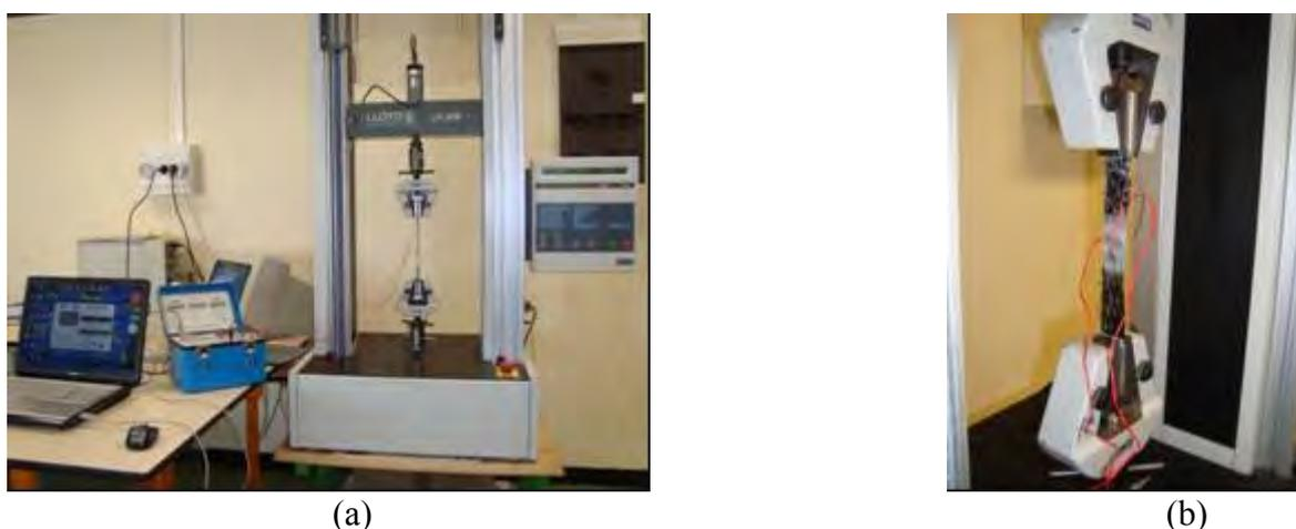
**Figure II.1. 4:** (a) dispositif de l'essai de traction et (b) éprouvette en fibres de carbone
