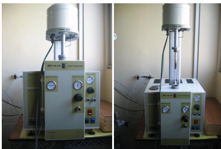
Figure IV-13 : Dispositif utilisé pour l'analyse thermogravimétrique – Université d'Orléans
