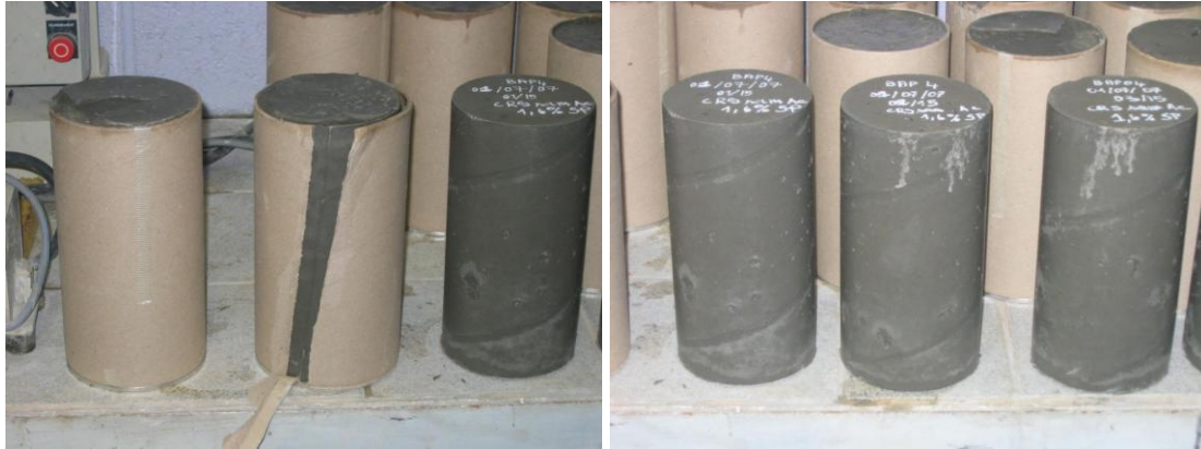
Figure III-6 : Confection des éprouvettes cylindriques en béton autoplaçant
