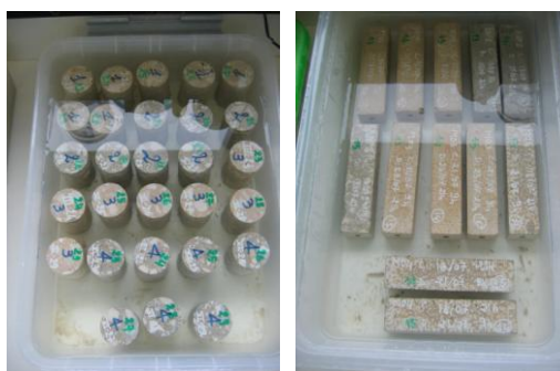
Figure III. 12 : Immersion des échantillons de l'eau dosée à 5 % de \text{Na}_2\text{SO}_4 \cdot 10\text{H}_2\text{O}
