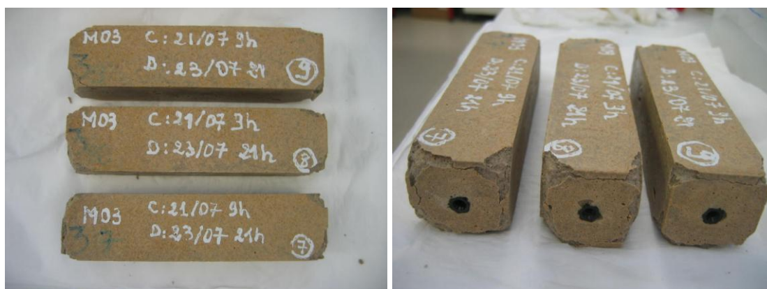
Figure III-55 : Endommagement des mortiers en CEMII/49 au cinquième mois Immersion complète
