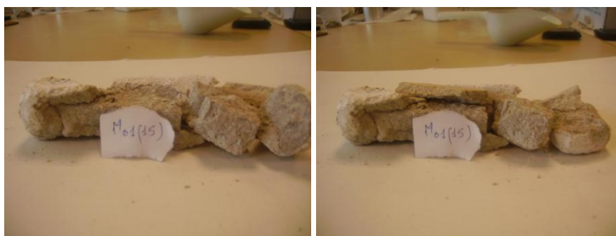
Figure III-29 : Ruine totale des mortiers issus des bétons CEMII/59 en Immersion/séchage à 105°C
