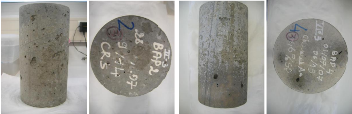
Figure III-47 : Etat intact des éprouvettes 11x22 cm en CEM I/59 et en CEM I/49 après 6 mois d'immersion complète
