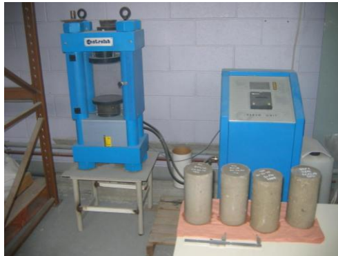
Figure I-14 : Mesure de la résistance à la compression des 11x22 cm
