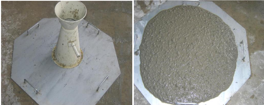
Figure I-3 : Essai d'étalement au cône d'Abrams (slump flow)
