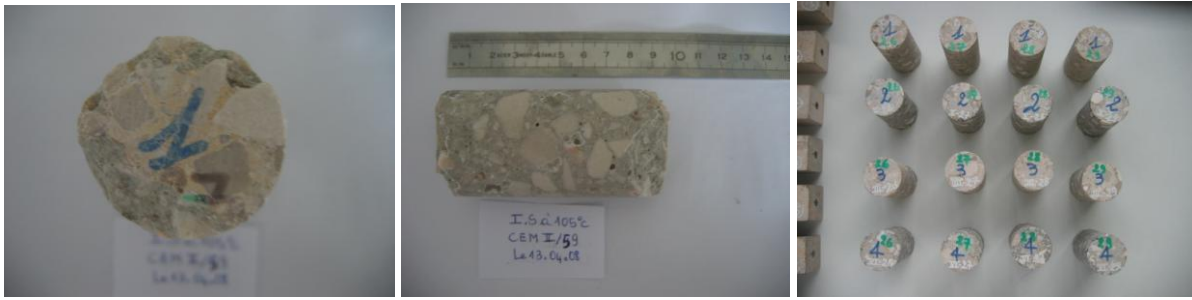
Figure III-32 : Echantillons mini-cylindriques en béton ayant subi l'immersion/séchage à 105°C
