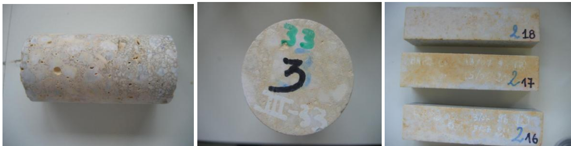
Figure III-22 : Mini-cylindres de béton et des mortiers soumis au brouillard salin
