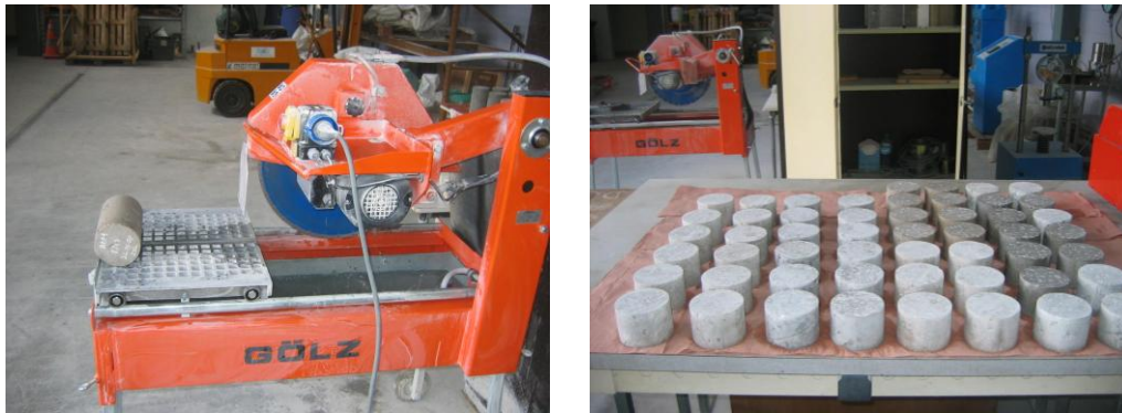
Figure III-9 : Sciage des éprouvettes 11 x 22 cm de béton en éprouvettes 8 x 22 cm.
