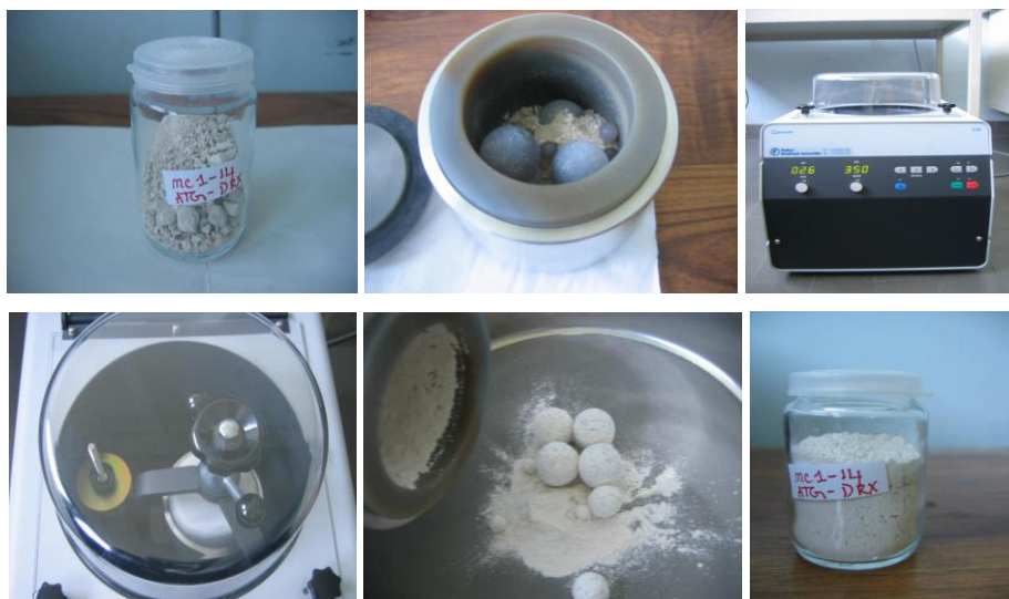
Figure IV-12 : Préparation des échantillons pour l'ATG et la DRX
