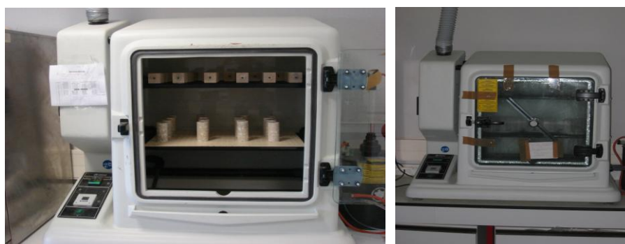
Figure III. 16 : Armoire à condensation du SO 2
