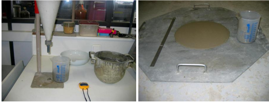
Figure II-18 : Essai de mesure du seuil de cisaillement selon Roussel et Goussot
