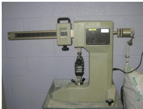
Figure I-15 : Mesure de la résistance à la traction par flexion des 4x4x16 cm
