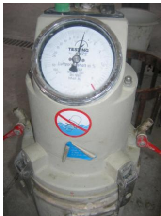
Figure I-11 : Mesure de l'air occlus à laide d'un aéromètre
