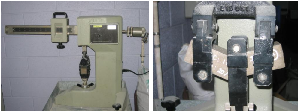
Figure III-5 : Machine du calcul de la résistance à la flexion des mortiers de l'École Polytechnique d'Orléans
