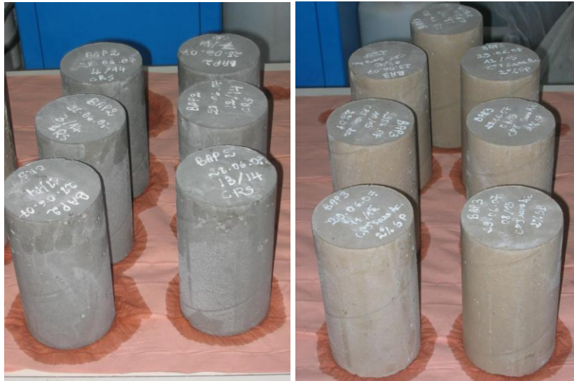
Figure I-12 : Parement d'un béton autoplaçant
