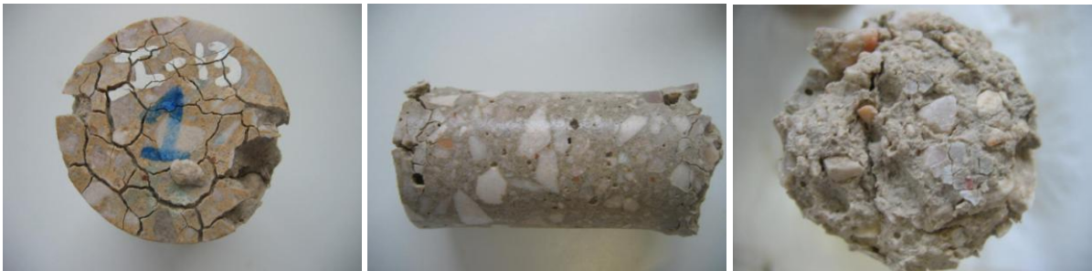
Figure III-50 : Ruine des mini-cylindres en CEMII/59 Immersion complète à 3 mois jours
