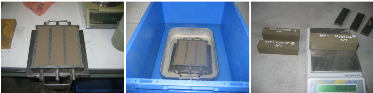
Figure III-7 : Confection des éprouvettes prismatiques en mortier autoplaçant
