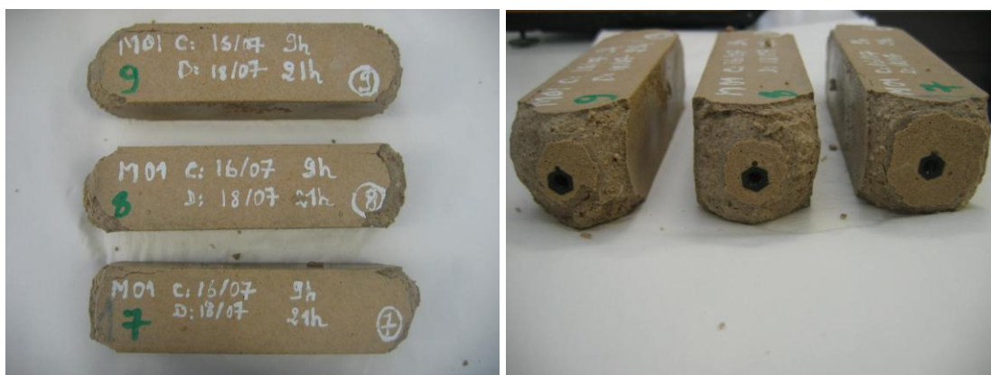
Figure III-54 : Endommagement des mortiers en CEMII/59 au quatrième mois Immersion complète
