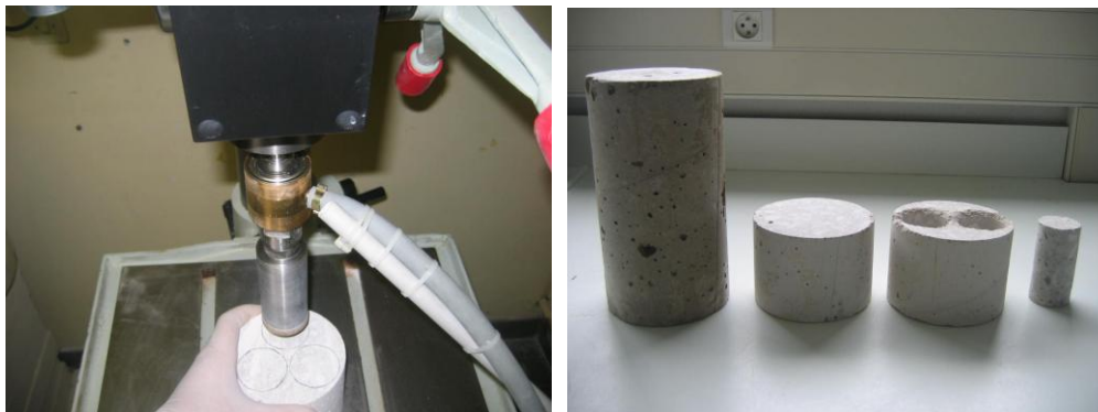
Figure III-11 : Confection des mini-cylindres en béton
