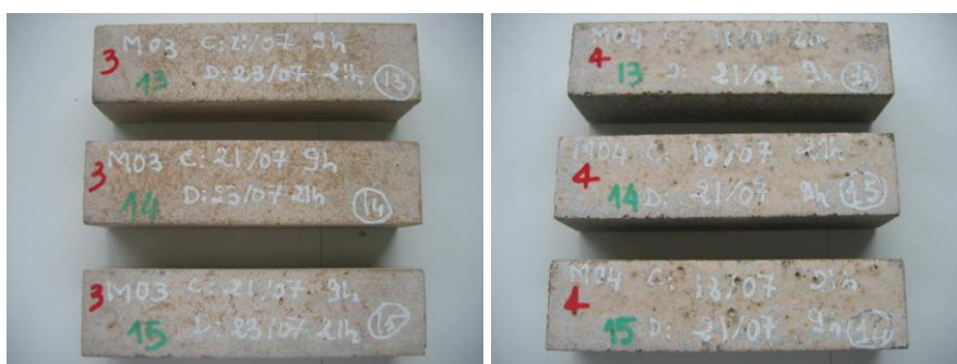
Figure III-31 : Echantillons de mortier issus des bétons CEMII/49 et CEMI/49 restés intacts face à l'immersion/séchage à 105°C
