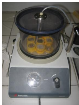
Figure IV-28 : Mise sous vide des échantillons à surfaces polies
