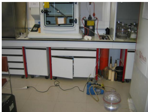
Figure III. 17 : Dispositif de purge de l'armoire à condensation du SO 2
