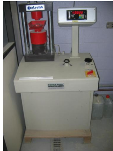
Figure I-16 : Mesure de la résistance à la compression sur demi-prismes
