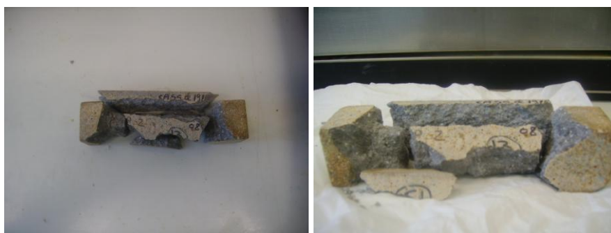
Figure III-30 : Ruine totale des mortiers issus des bétons CEMI/59 en Immersion/séchage à 105°C
