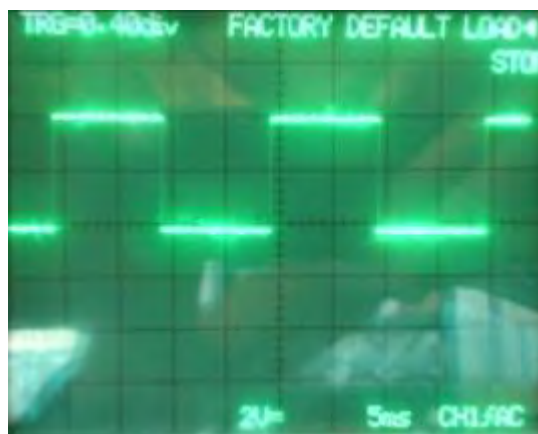
Fig.(IV.13) : La forme de la tension obtenue aux bornes de la résistance
