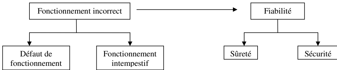
Fig. II.3 - Fiabilité d'une protection.
