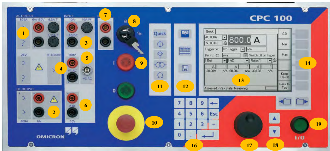
Fig.V.5 - Vue avant de la caisse d'injection Omicron [36].
