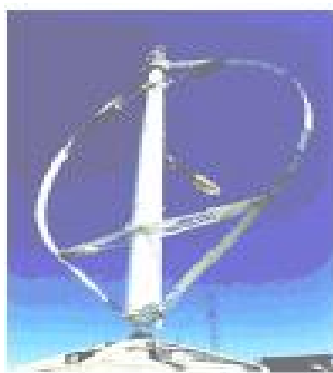
Figure 1.2 : éolienne à axe vertical [7]
