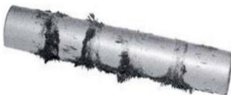
Figure 1.2. Tube magnétique à aimant permanent (ferrites, terres rares) [Mehasni 2007].
