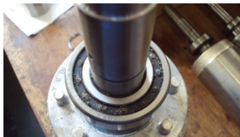
FIGURE 4.11 – Vue de face d'un roulement NUP206 après ajout de contaminant
