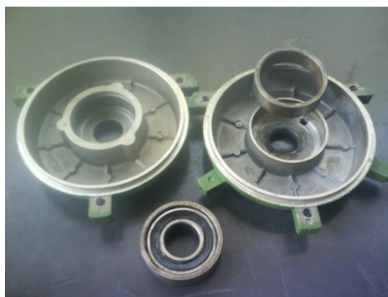
FIGURE 3.15 – Montage d'une excentricité statique [3].
