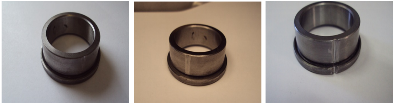
FIGURE 4.12 – Défaut de bague interne sur le roulement NUP206 (niveau 1/3,2/3 et 3/3 dans l'ordre de gauche à droite) [Guendouz]
