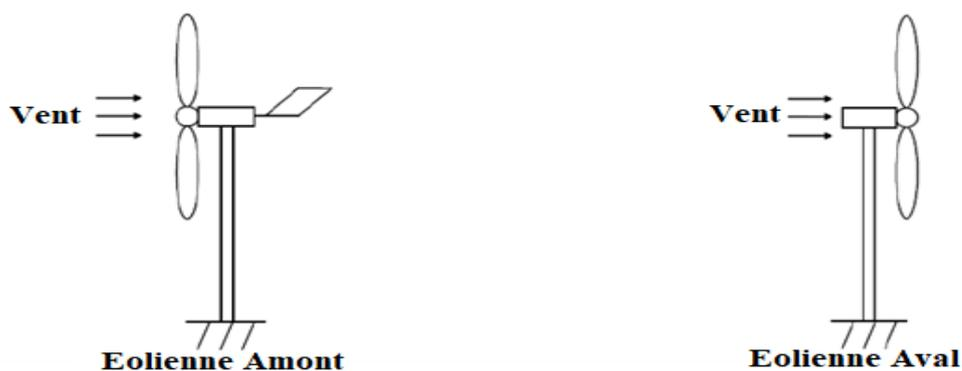
**Figure I.9** Type de configuration d'éolienne à axe horizontal.
