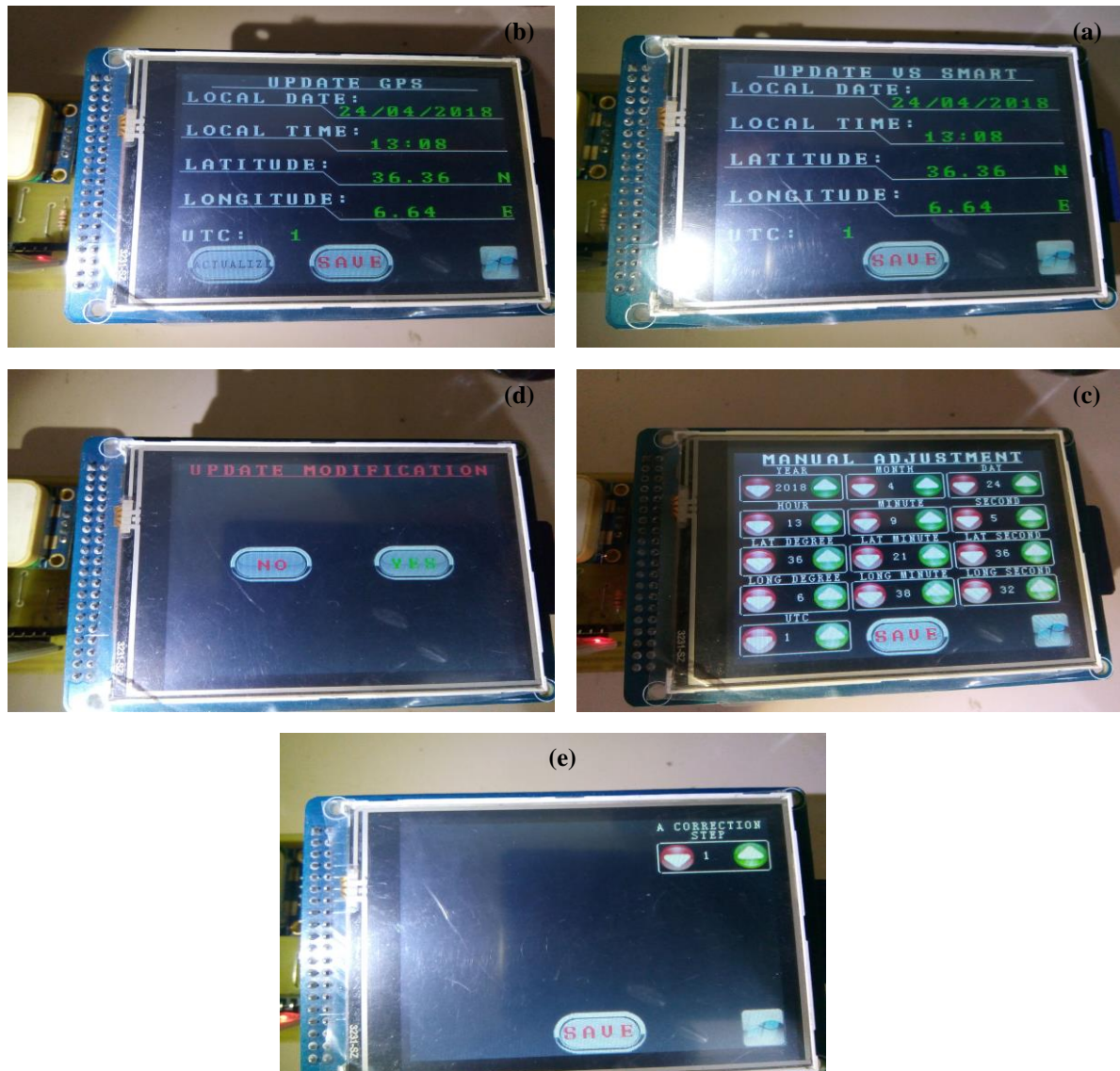
Figure IV.22 Différentes fenêtres programmées sur l'écran tactile
