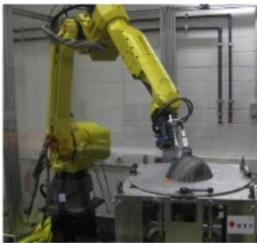
Figure I.35. Robot à CF « Fraunhofer IKTS-MD » pour scanner les CFRP [40].
