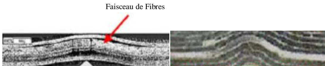
Figure I.23. Défaut d'ondulation de fibre de carbone [28].
