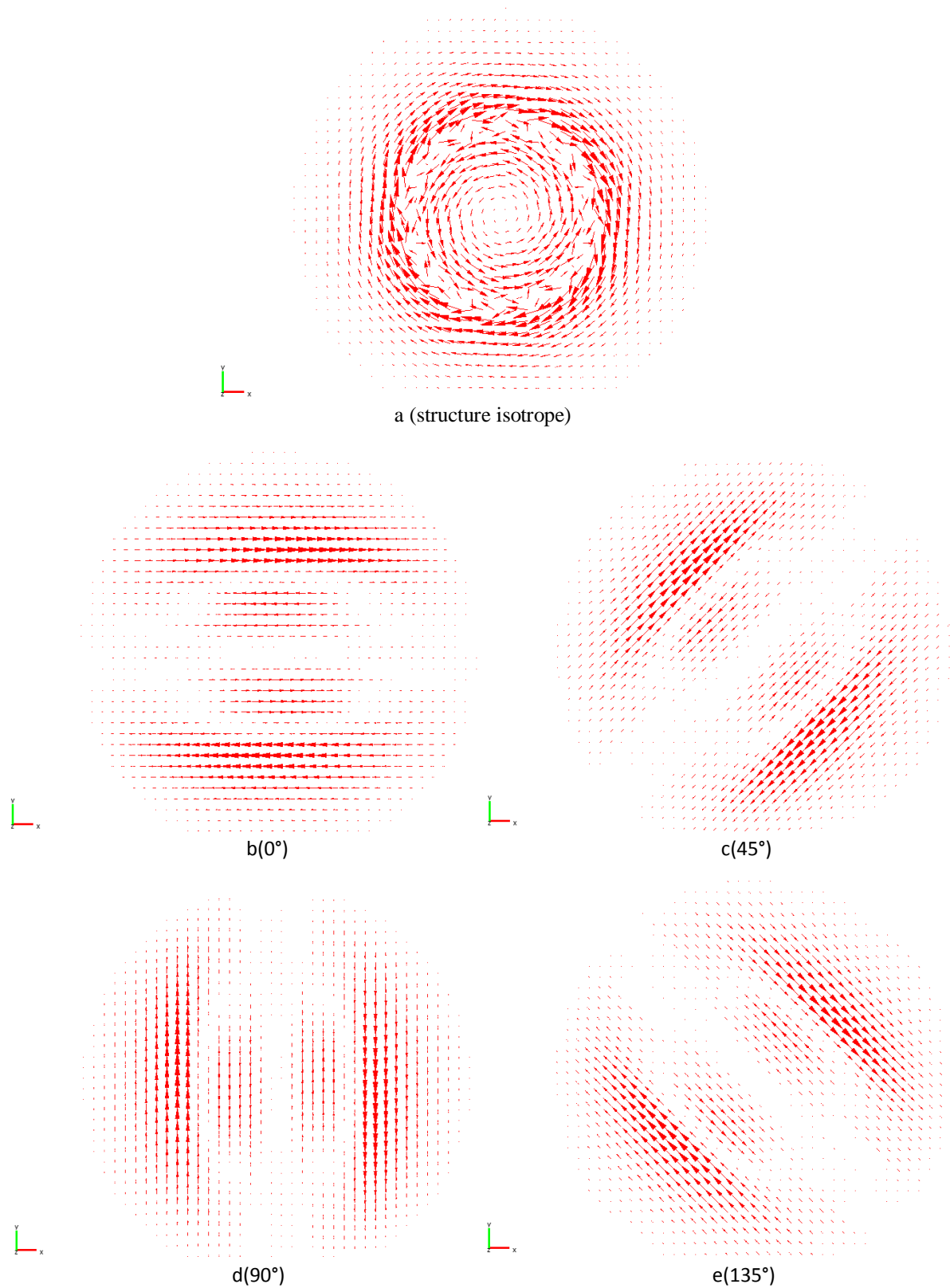
Figure III.11. Comparaison entre la distribution vectorielle des courants induits dans les quatre échantillons de CFRP par rapport à un échantillon isotrope.
