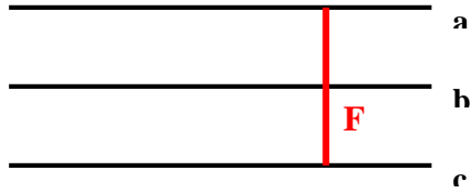
Figure 5 - Défaut entre trois lignes
