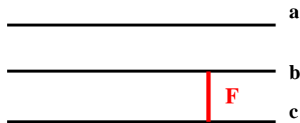
Figure 7 - Défaut entre phases (b et c)
