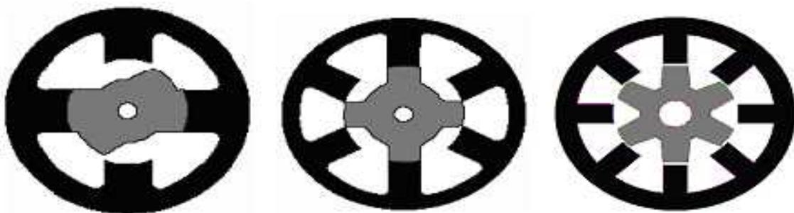
(a) MRV à deux phases 4/2 (b) MRV à trois phases 6/4 (c) MRV à quatre phases 8/6
