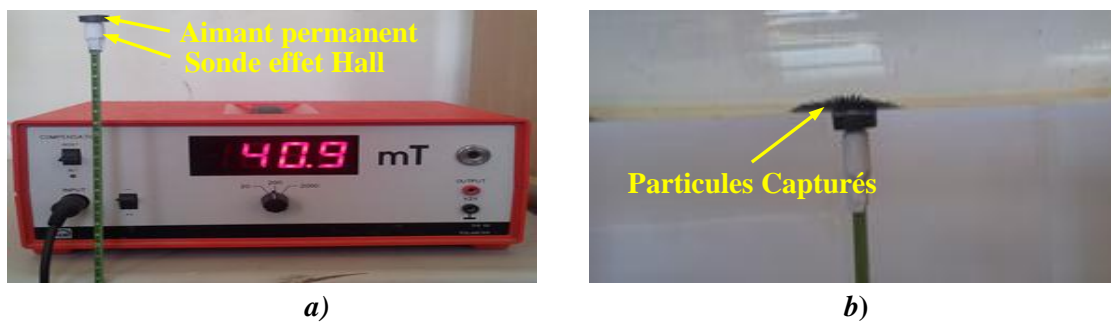
Figure 5.6. Dispositif de mesure réalisé, a) Teslamètre et éléments associés (aimant permanent et sonde à effet Hall), b) Mesure du champ en présence du dépôt des particules séparées.
