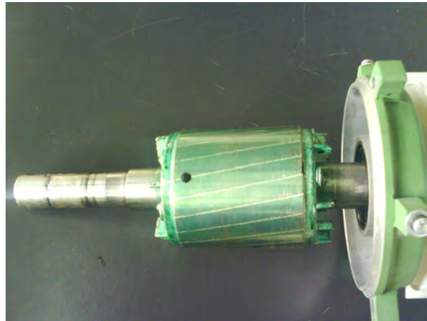
Fig. I.29 : Cassure de barre rotorique (perçage d'une barre)
