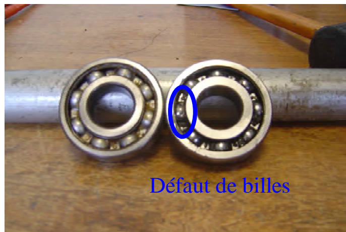
Fig. I.25 : vue des roulements sains et défectueux (billes écorchées)
