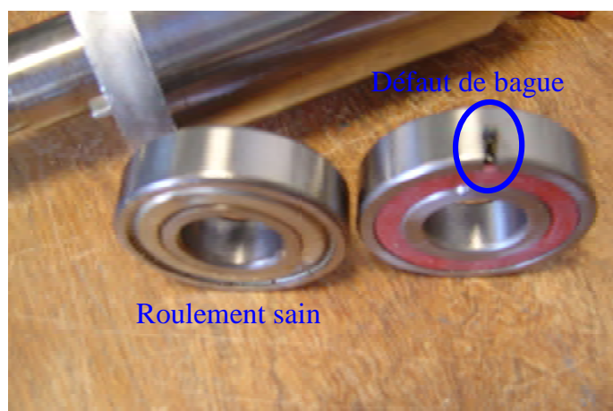
Fig. I.21 : vue des roulements sains et défectueux (bague cassée)
