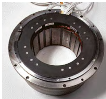
Figure I.5 Stator d'un centreur magnétique
