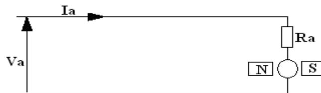
Fig. (4.7): machine à courant continu à aimant permanent.
