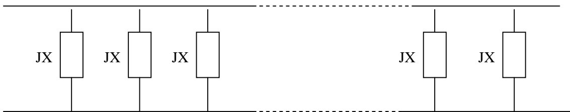
Fig1.10-a : Schéma équivalent d'un filtre à inductif
