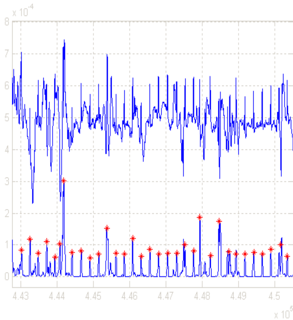
Figure 2.17 : ECG très bruité, mais le filtrage a permis de distinguer les QRS dans le signal à seuiller (enregistrement 105.)
