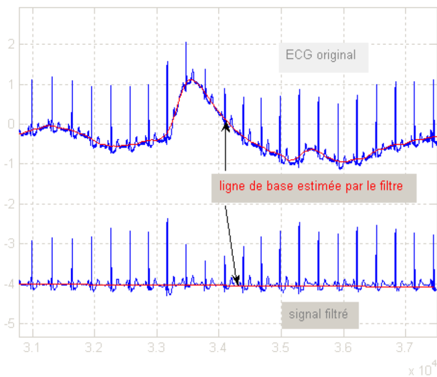
Figure 3.4 : forme du signal de sortie ainsi que la ligne de base estimée par le filtre.
