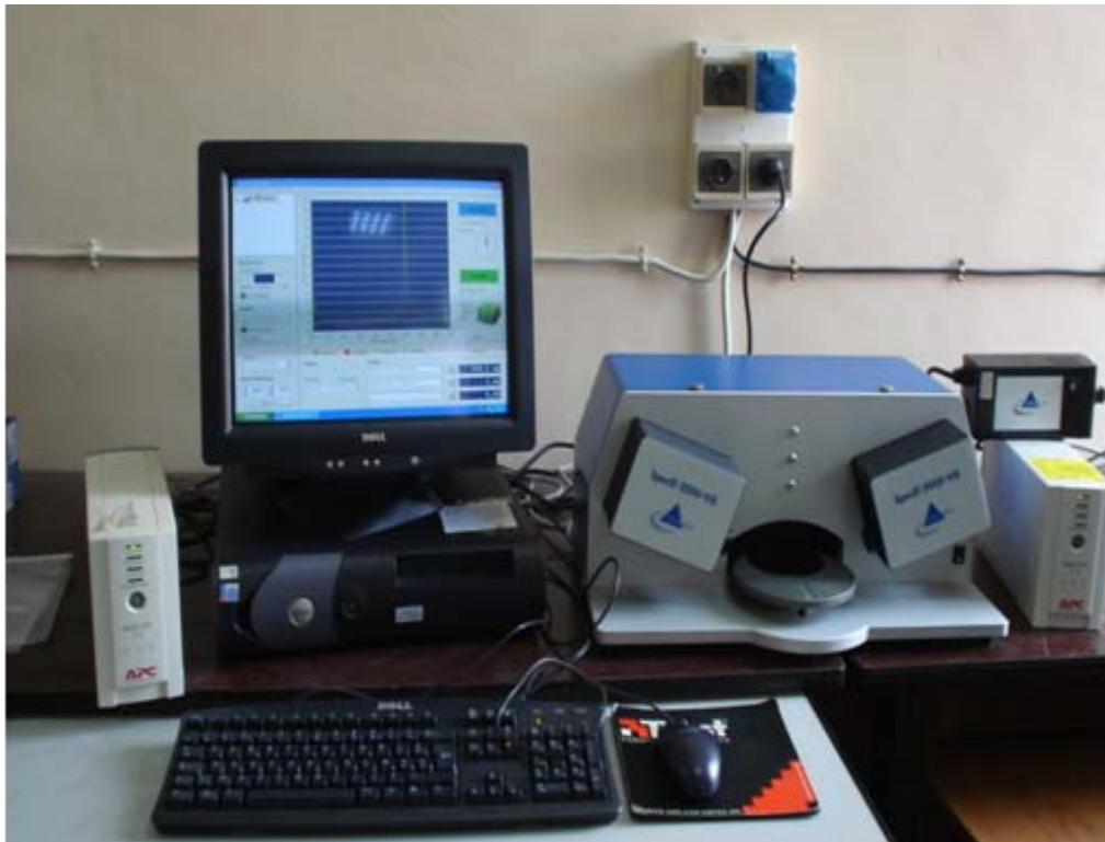
Fig.I.3: Ellipsomètre spectroscopique ( SpecEL-2000-VIS)
