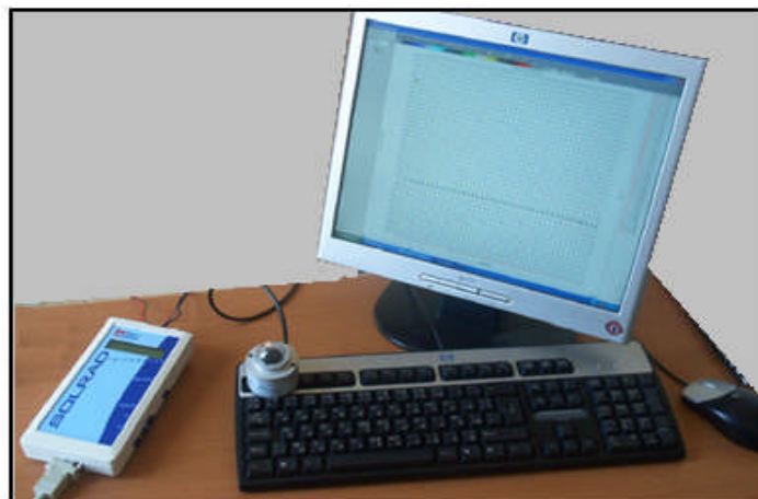
Figure. (IV.26) : mesure de l'ensoleillement par l'utilisation d'un Pyranometre, Intégrateur et un Ordinateur
