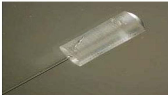
Fig.I- 2 : photo d'un capteur chimique à base de fibres optiques [5].
