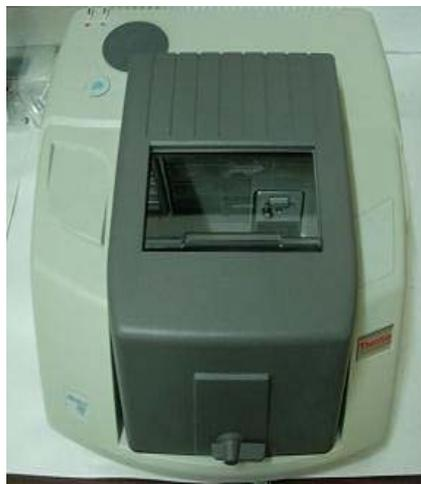
Fig.II- 8 : Photo d'un spectromètre infrarouge de type Thermo Nicolet Avatar 360 [63].
