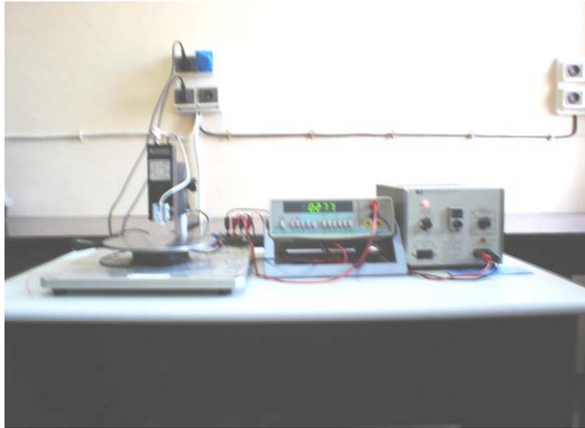
**Fig.II- 8 : photo du montage expérimentale d'une mesure par les quatre pointes.**
