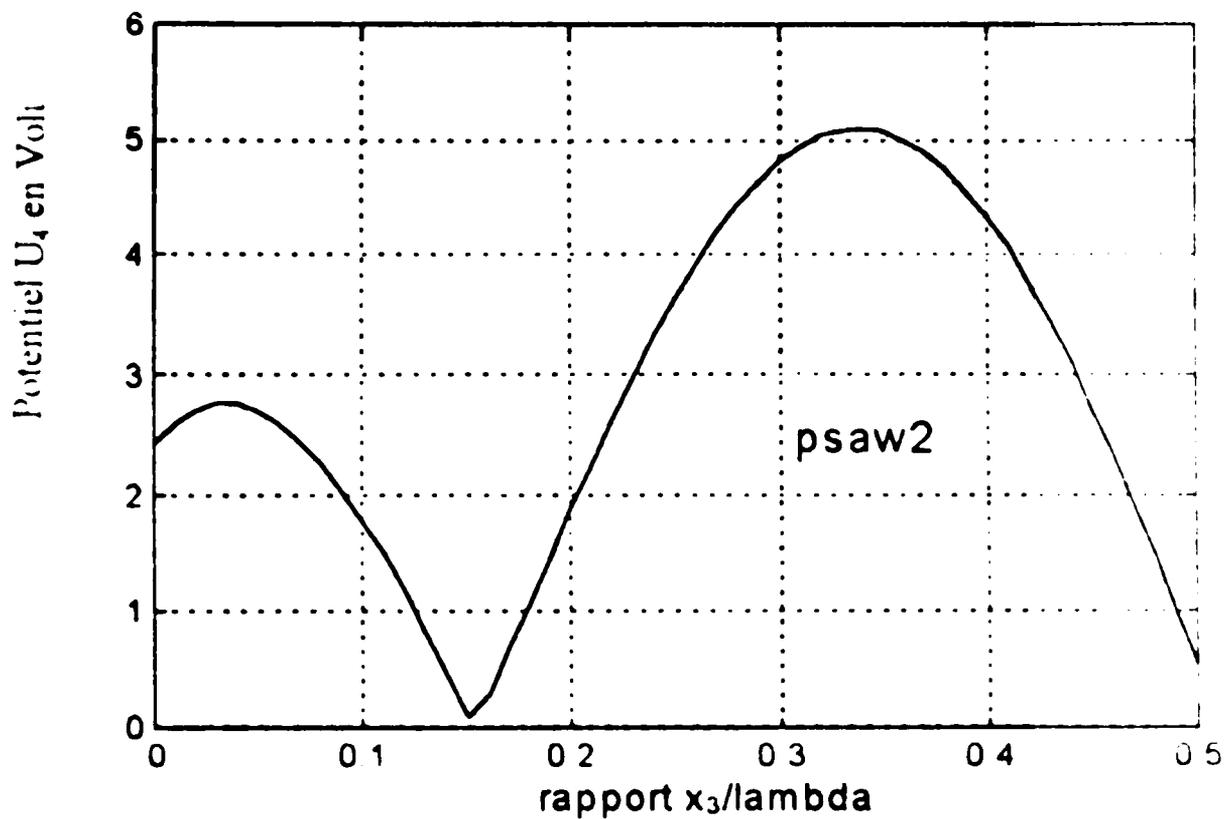
Fig. II-19 Le potentiel électrique de la pseudo SAW du second ordre. Cas du  $\text{LiTaO}_3$
