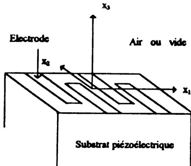
**Fig IV-1 Cristal semi-infini avec une source infinie suivant  $x_2$**
