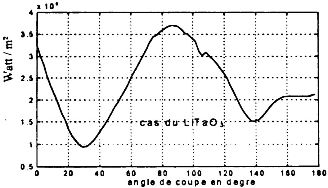
Fig. IV-11 Variations du flux de la puissance des pseudo SAW suivant  $x_2$  en fonction de l'angle de coupe pour  $t = 10^{-4}$  m.
