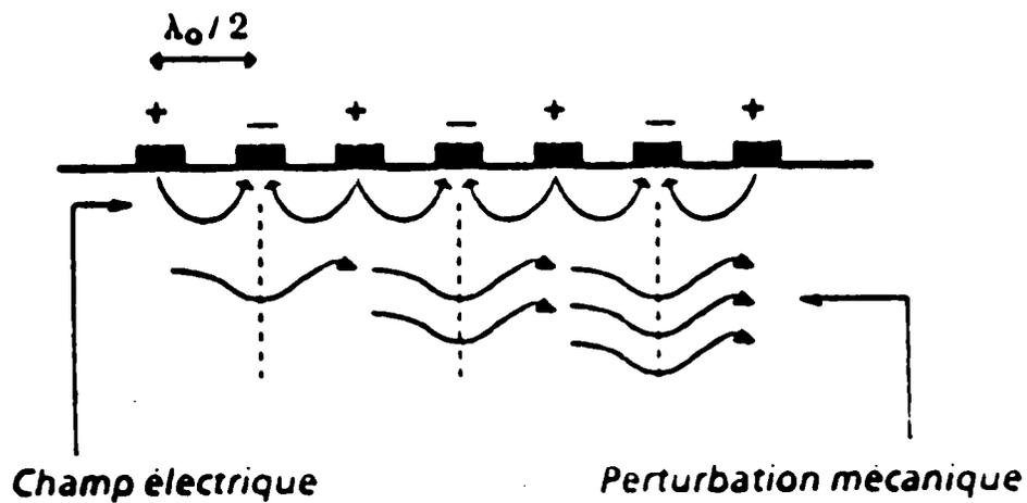
Fig II-2: Interférences constructives en onde de surface
