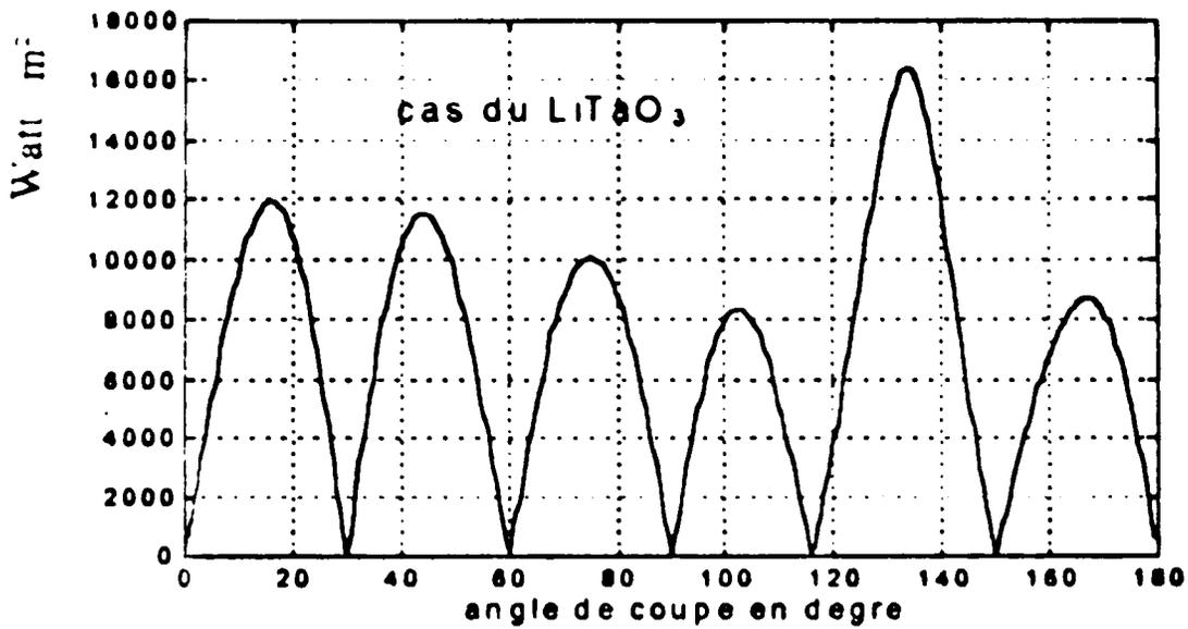
Fig. IV-6 Variations du flux de la puissance des ondes de volume suivant  $x_2$  en fonction de l'angle de coupe.
