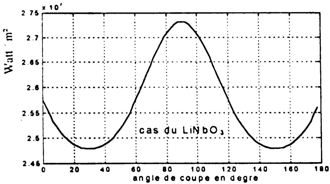
Fig. IV-10 Variations du flux de la puissance des pseudo SAW suivant  $x_1$  en fonction de l'angle de coupe pour  $t = 10^{-4}$  m.
