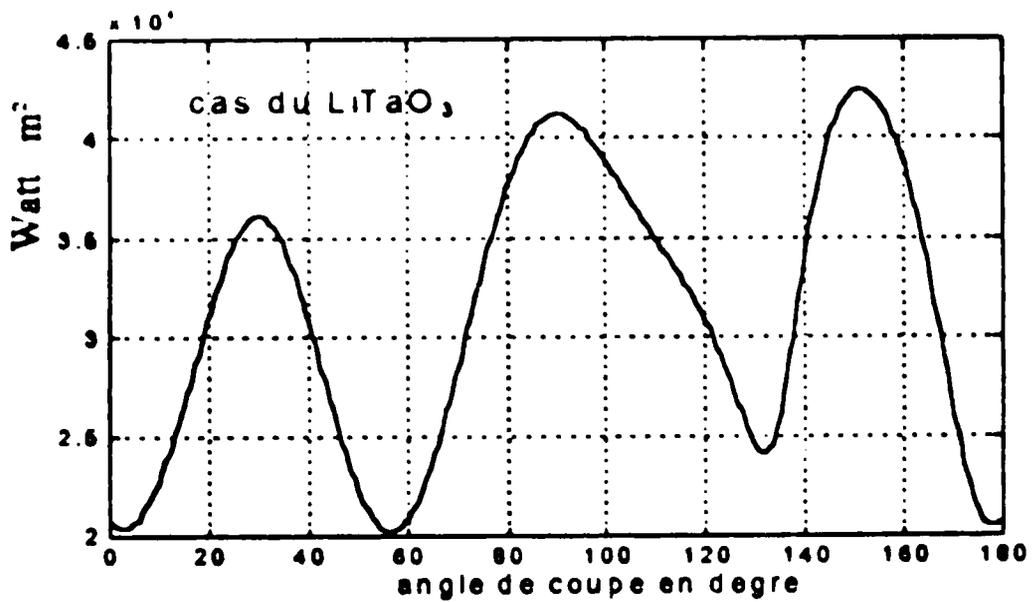
Fig. IV-5 Variations du flux de la puissance des ondes de volume suivant  $x_1$  en fonction de l'angle de coupe.
