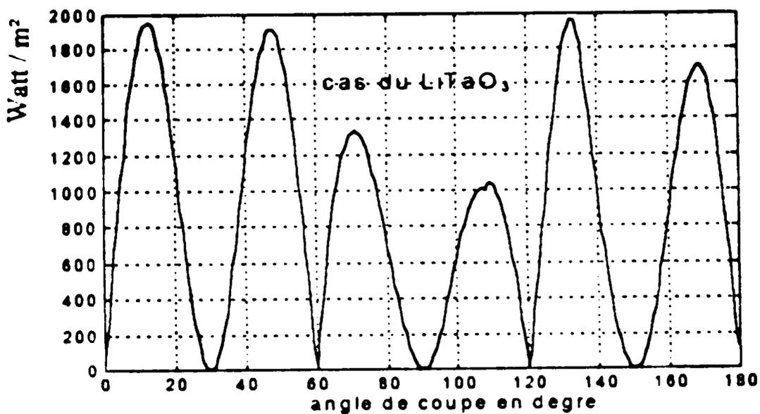
Fig. IV-7 Variations du flux de la puissance des ondes de volume suivant  $x_3$  en fonction de l'angle de coupe.
