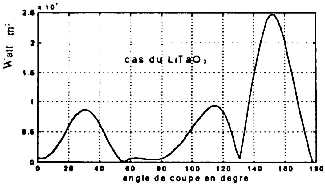
**Fig. IV-9** Variations du flux de la puissance de l'onde SAW suivant  $x_2$  en fonction de l'angle de coupe.
