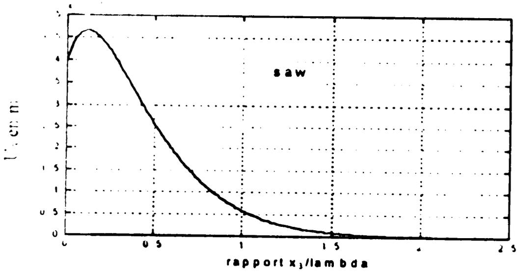
Fig. II-10 Déplacements acoustiques de l'onde SAW.
