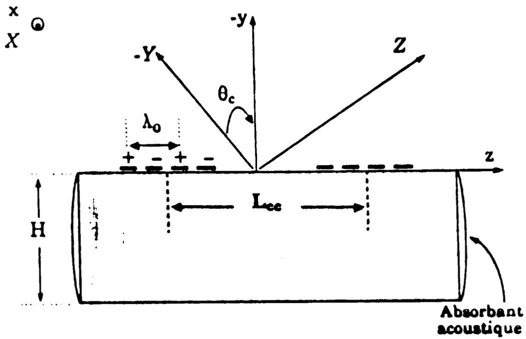
Fig III- 7 Dispositif à ondes TH dans une plaque
