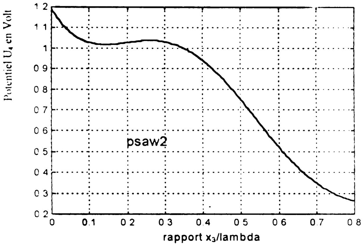
Fig. II-17 Le potentiel électrique de la pseudo SAW du **second** ordre. Cas du  $\text{LiNbO}_3$
