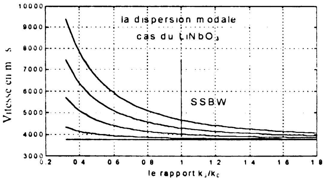
Fig. III-17 Variations de la vitesse normalisée en fonction de  $K_3 / K_0$  pour  $H / \lambda_0 = 1$ , coupe Y.
