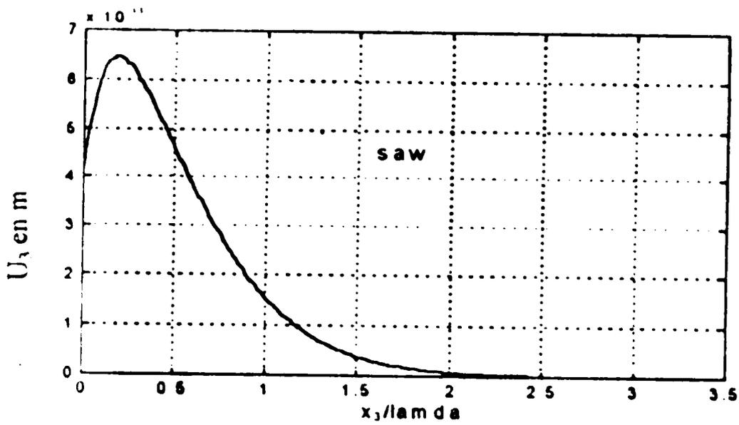
Fig. II-8 Déplacements acoustiques de l'onde SAW.
