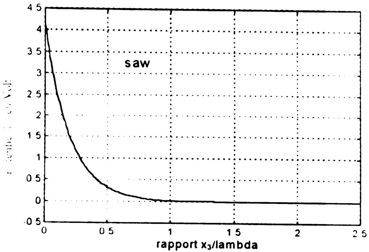
Fig. II-11 Potentiel électrique de l'onde acoustique de surface.
