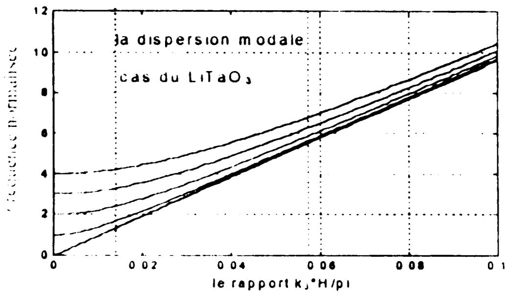
Fig. III-16 Variations de la fréquence normalisée en fonction de  $K_3 / K_0$  pour  $H / \lambda_0 = 2.9$ . Coupe Y
