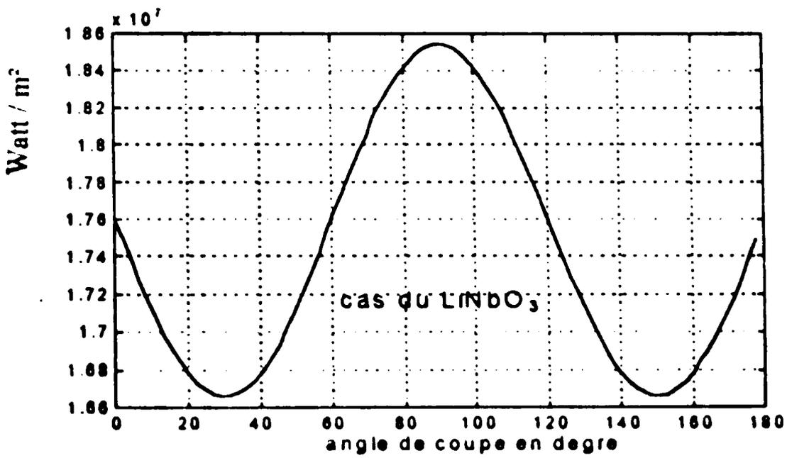
**Fig. IV-12** Variations du flux de la puissance des pseudo SAW suivant  $x_3$  en fonction de l'angle de coupe pour  $t = 10^{-4}$  m.
