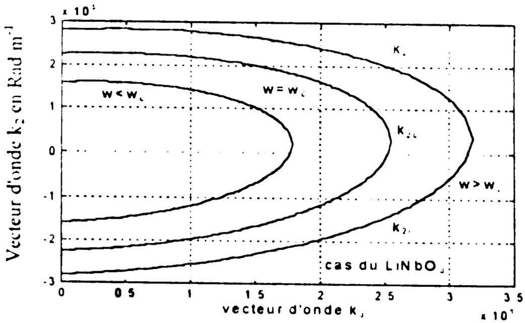
Fig III-6 Evolution de la courbe de lenteur de l'onde T.H pour trois pulsations.
