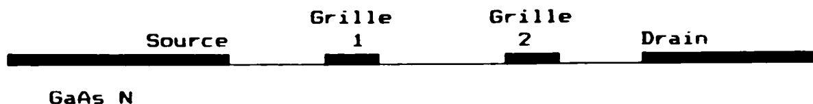
Fig 1.1. Coupe transversale de la couche active du MESFET bigrille
