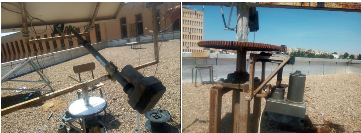
IV.13. Axes de rotation du système suiveur solaire implémenté.
