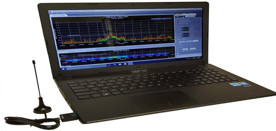
**Figure 3.10** Connexion RTL-SDR-PC
