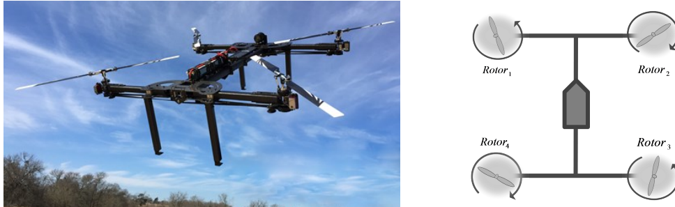
Figure 1.6. Exemple d'un quadri-rotor à configuration H : drone Manta-Ray.
