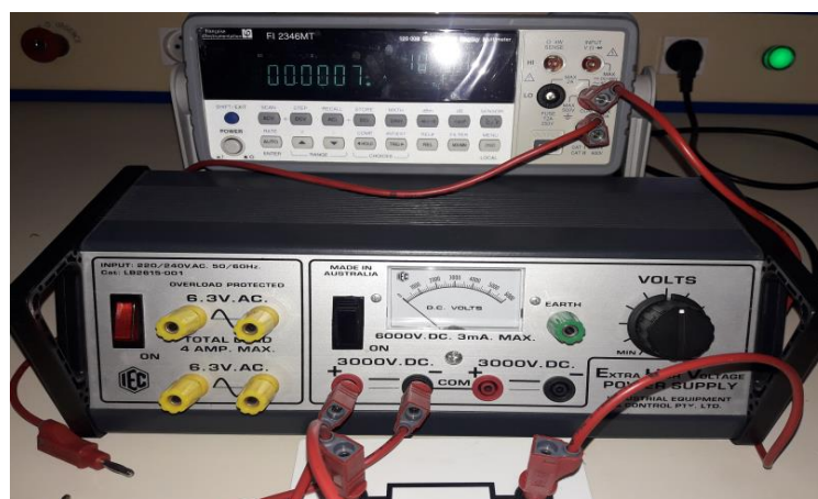
Figure III.20 — Montage des mesures courant tension I(V) .
