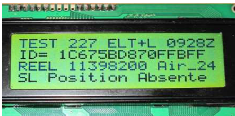
Figure 6.25- Trame transmise par une balise qui devrait donner sa position, mais le GPS de la balise ne fonctionne pas. L'heure de la réception est affichée.
