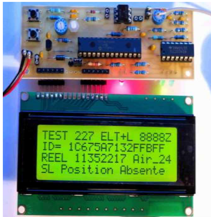
Figure 6.22- Avec le PIC programmé mis en place sur son support, l'écran d'accueil apparaît lors de la mise sous tension.
