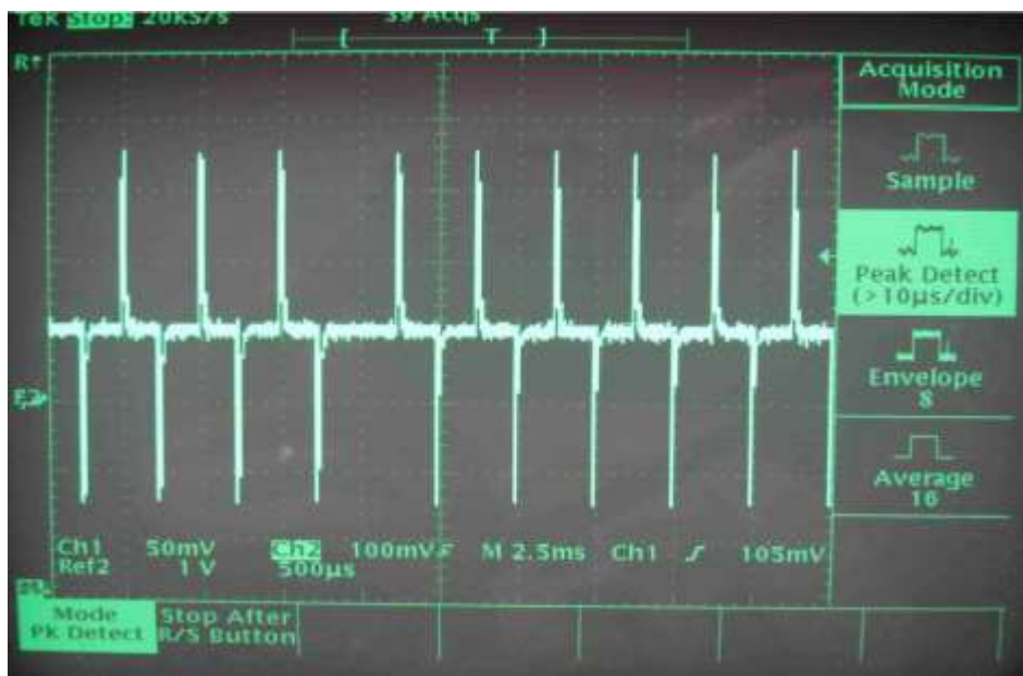
Figure 6.15- Signaux de sortie avec le filtre passe-haut. Ce sont les mêmes échelles que pour la photo 2. Les signaux de sortie sont maintenant sous forme de pics alternés.
