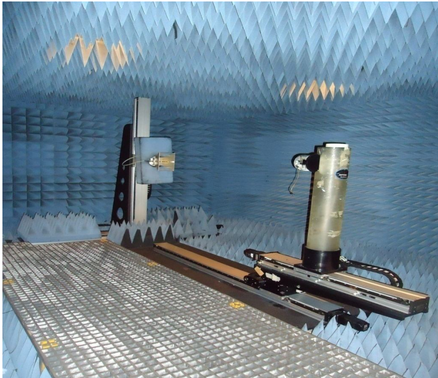
Figure IV.18. Chambre anéchoïque disponible au sein du laboratoire RF de l'INRS.
