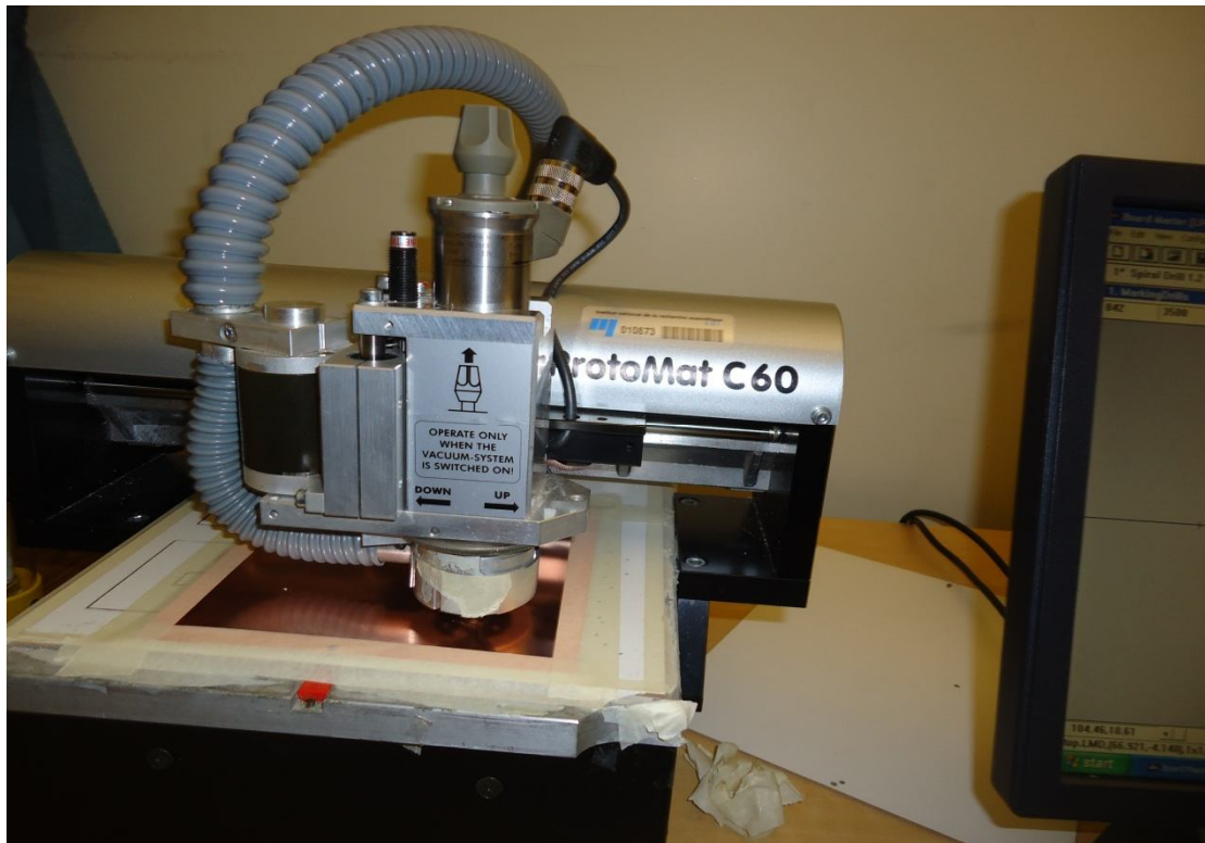
Figure IV.12. Découpage du substrat par la machine “LPKF ProtoMat C60”.
