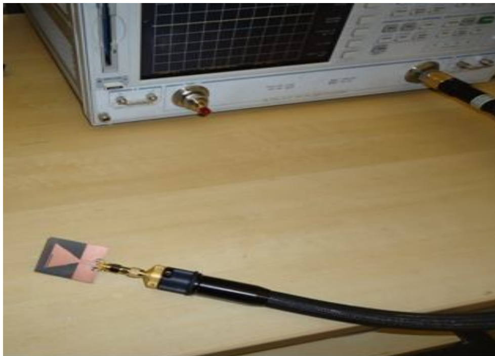
Figure IV.16. L'antenne fabriquée connectée à l'analyseur de réseau "Agilent 8722ES".
