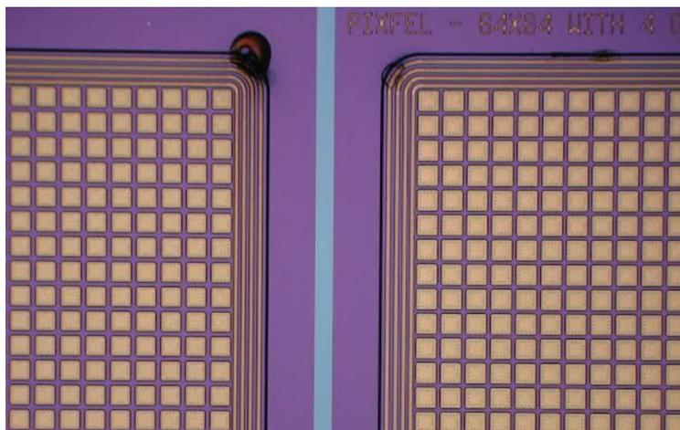
FIGURE 4.12 – Image microscopique de deux capteurs de 64x64 pixels avec quatre anneaux de garde montrant des défauts de bord.
