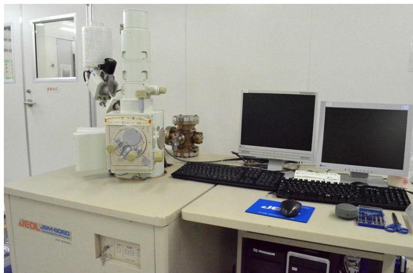
**Figure II. 14** : Microscope Electronique à balayage *JEOL JSM 6060*.
