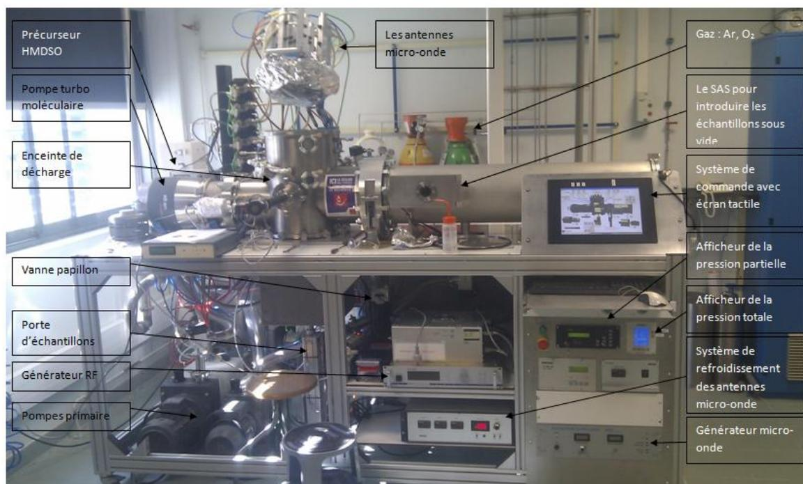
**Figure II. 5 :** Photographie du réacteur PMM-RCER.
