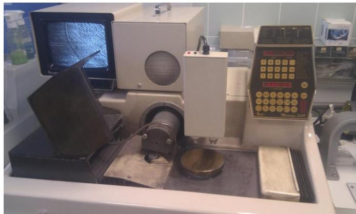
**Figure II. 25 :** Machine de découpe par pointe diamant (scriber) de l'AIME de Toulouse.
