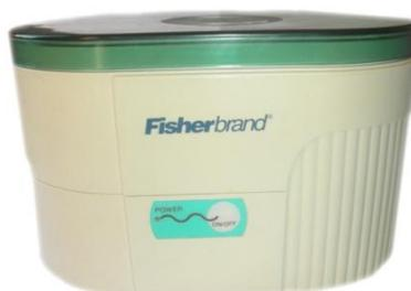
**Figure II. 26 :** Photo du bac de nettoyage par agitation à ultrasons.
