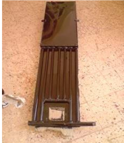
Figure IV.21 : L'échangeur après la peinture.
