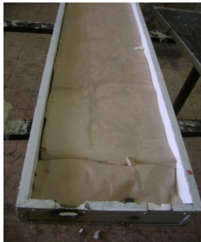
Figure IV.24 : Le caisson assurant l'isolation de prototype.
