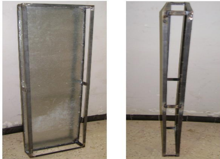
Figure IV.23 : le support métallique.
