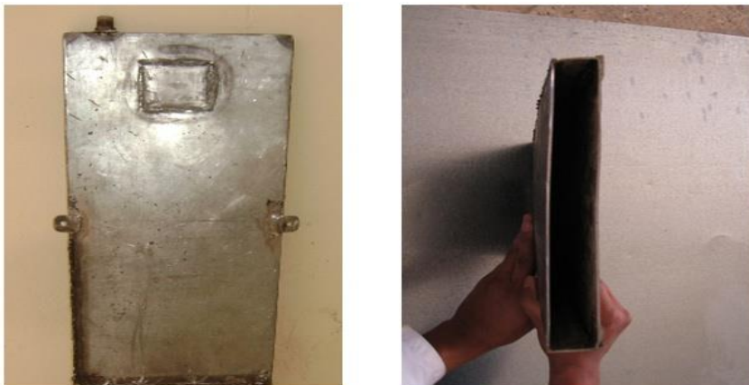
Figure IV.18 : Partie de l'enceinte constituant l'absorbeur.
