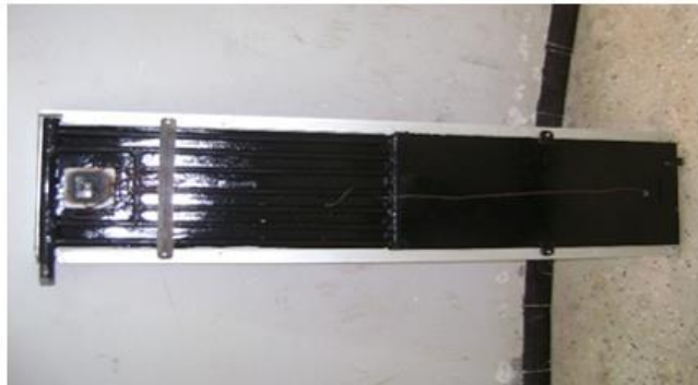
Figure IV.22 : Photo de l'échangeur collé sur la face arrière du module PV.
