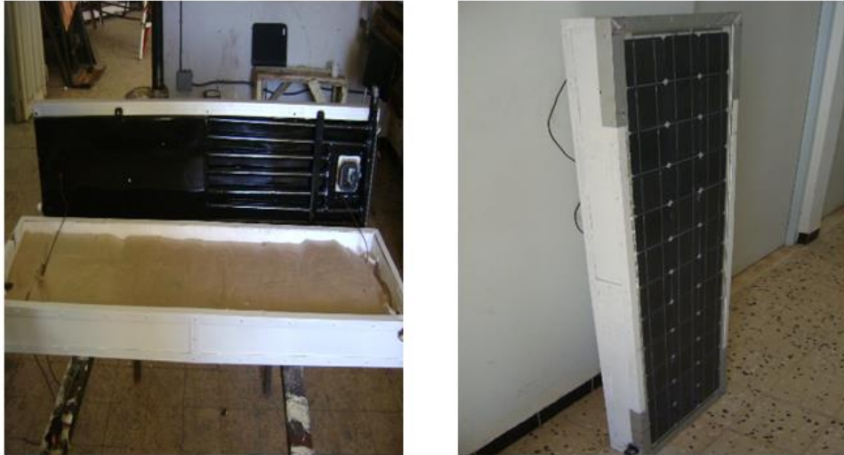
Figure IV.25 : Le capteur hybride PVT complet.
