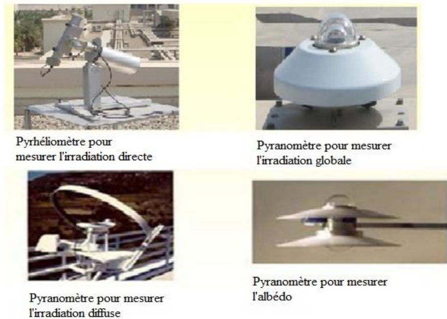
Figure I. 9 : les différents instruments pour la mesure des différents composants de rayonnements. [5]
