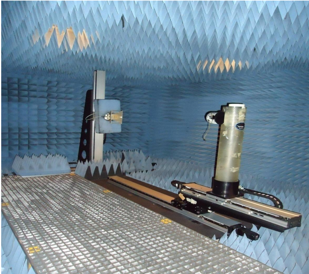
Figure IV .23 : La chambre anéchoïde de l'INRS pour mesurer le diagramme de rayonnement.
