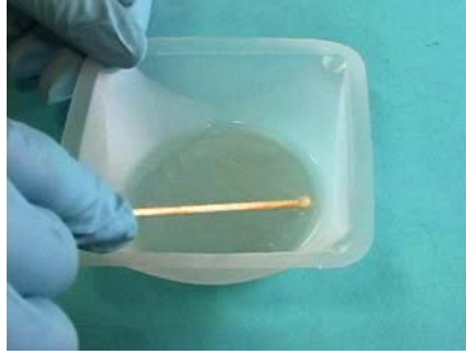
Figure IV.21 : Le mélange de l'agent de durcissement et de prépolymère pour obtenir le PDMS
