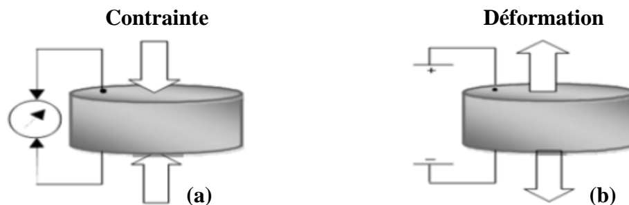
Figure I.2 : L'effet piézoélectrique : (a) effet direct, (b) effet inverse
