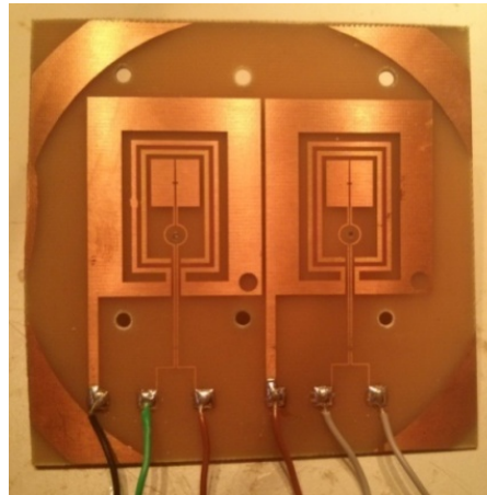
Figure IV.18 : Photographie de la plaque inférieure du PCB contenant l'électrode de cuivre et les fils de connexions électriques
