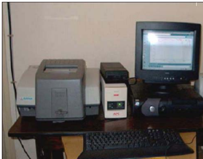
Figure 2.9 : spectrophotomètre FTIR de type Thermo Nicolet Avatar 360
