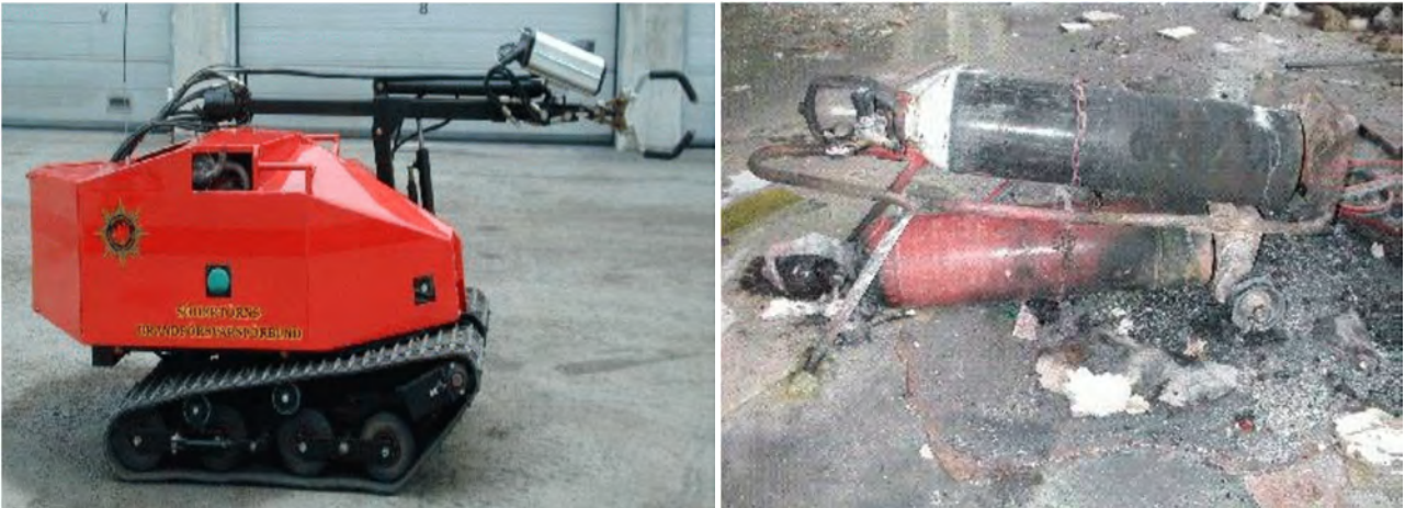
Figure 1.14- Un exemple de tâche: commander à distance le robot (a gauche) pour identifier et localiser les tubes de gaz présentant un risque d'explosion (a droite)
