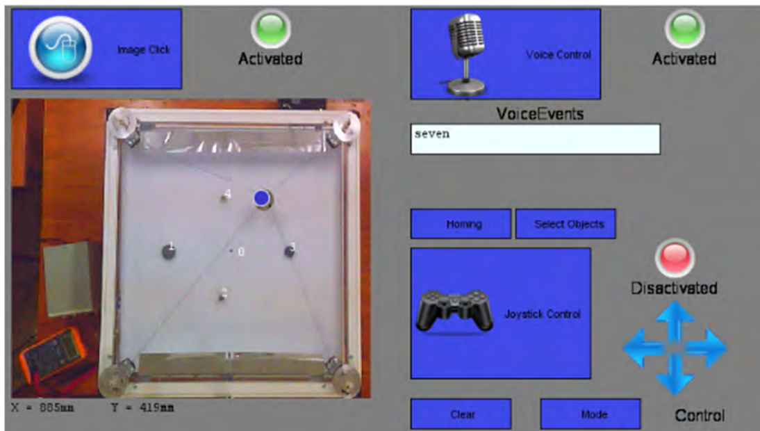
Figure 4.13- La localisation automatique de l'effecteur final sur l'espace du travail
