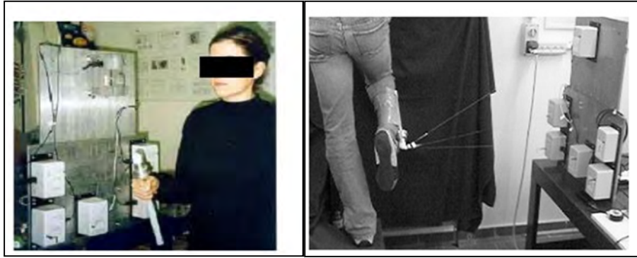
Figure 1.28- Représentation d'un capteur de force pour les robots à câbles (CaTraSys)
