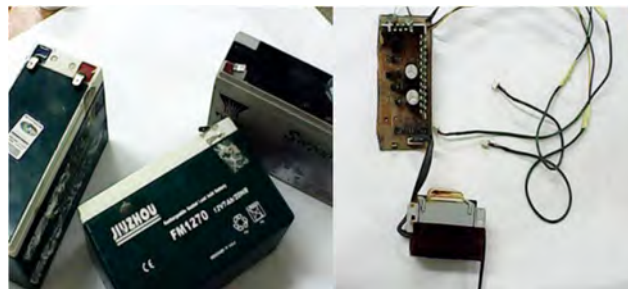
Figure 2.26- Les sources d'alimentation du robot à 3 câbles
