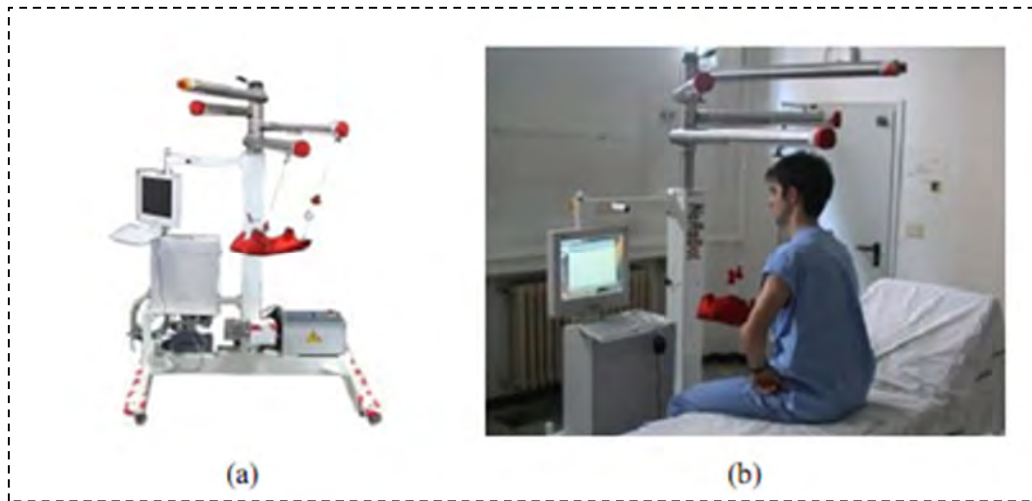
Figure 1.33- NeReBot est un robot à câble pour la réadaptation de membre supérieure avec 3 ddl
