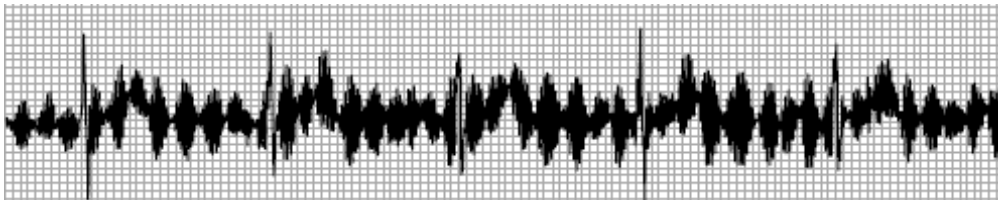
Fig. 1.26. Interférences électriques du secteur.
