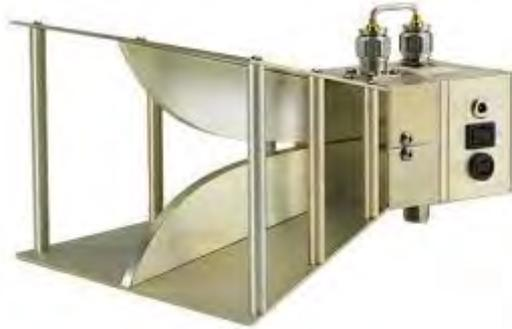
Figure IV.16. L'antenne de référence cornet AH-118
