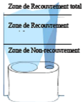
Fig III.8 —Représentation schématique de la zone de recouvrement
