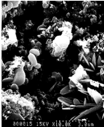
Fig IV.1 – Vue à fort grossissement ( \times 10000 ) d'un filtre de prélèvement d'aérosols en milieu urbain
