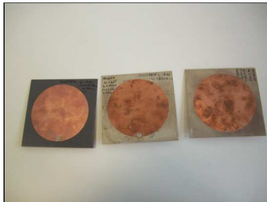
Figure II.11 Structures des résonateurs réalisés pour différents substrats
