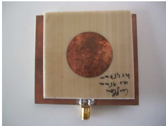
Figure II.10 Structure réalisée équipée de son connecteur SMA
