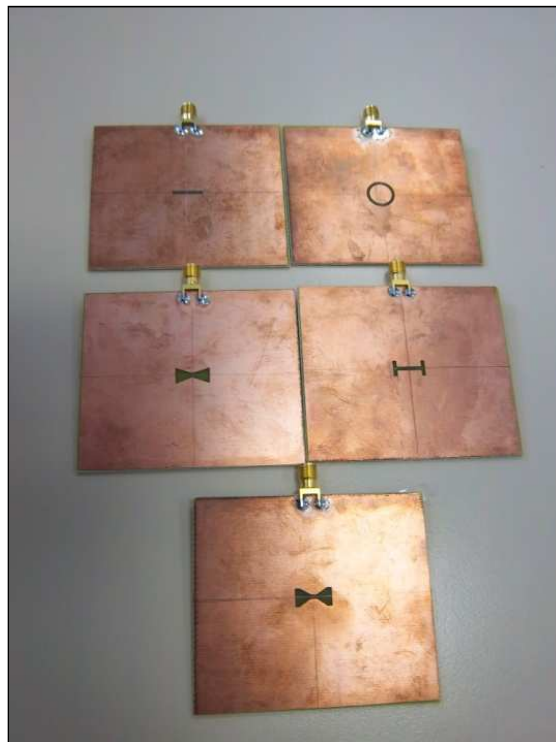
Figure IV.15 Alimentations pour différentes formes d'ouverture réalisées : rectangulaire, annulaire, nœud papillon (Bowtie), de forme « H », Sablier (Hour glass), respectivement.
