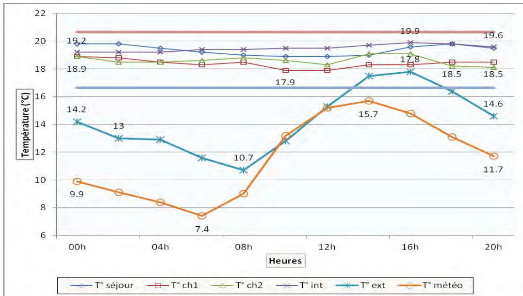
Fig. V. 39 : Evolution de la température intérieure et extérieure le 1 er avril 2010 au dernier étage. (Source : Auteur 2010)
