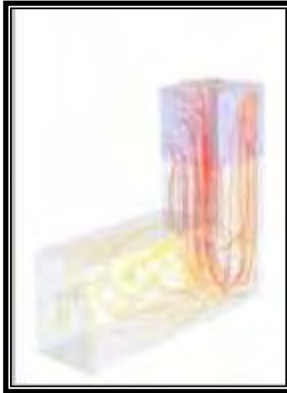
Figure 3.53 : Simulation informatique du cheminement de l'air dans une tour à vent à Dubaï : le flux principal du vent (en rouge) crée une dépression dans la pièce, aspirant l'air frais des fenêtres (en jaune). Source Richard-Tolouie 2006.
