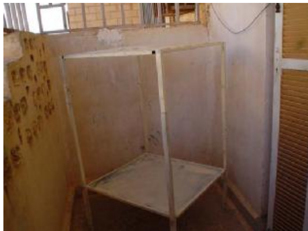
Photo V. 1 : Le cube métallique sur le quel l'isolation est fixée.
