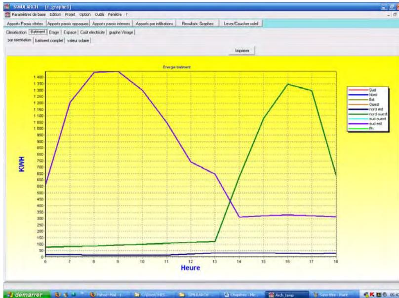
**Figure 51** Courbe d'évolution de l'énergie incidente sur différentes Orientations de parois opaques pendant la journée du 15 août à Constantine
