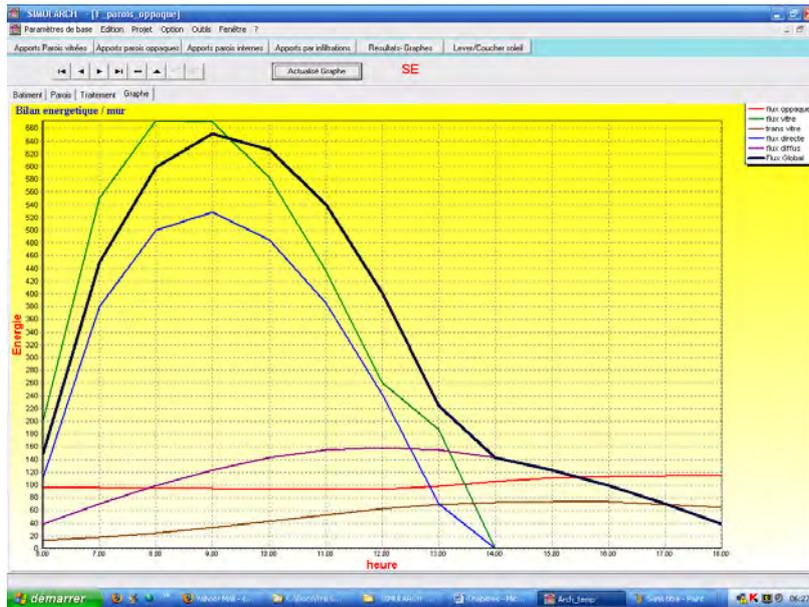
Figure 49 Courbe d'évolution de l'énergie incidente sur un plan vertical (SE) Pendant la journée du 15 août à Constantine
